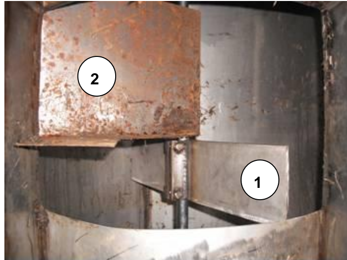
Abb. 10: Austragssystem in Variante 3 mit Räumler (1) und Abstreifblech (2)
