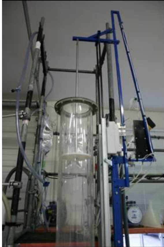
Abb. 7: Einheit zur automatisierten Substratbeschickung des AFR
