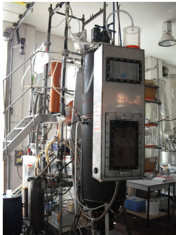
Abb. 11: AFR mit angebrachten Sammelbehälter (Variante 3)
