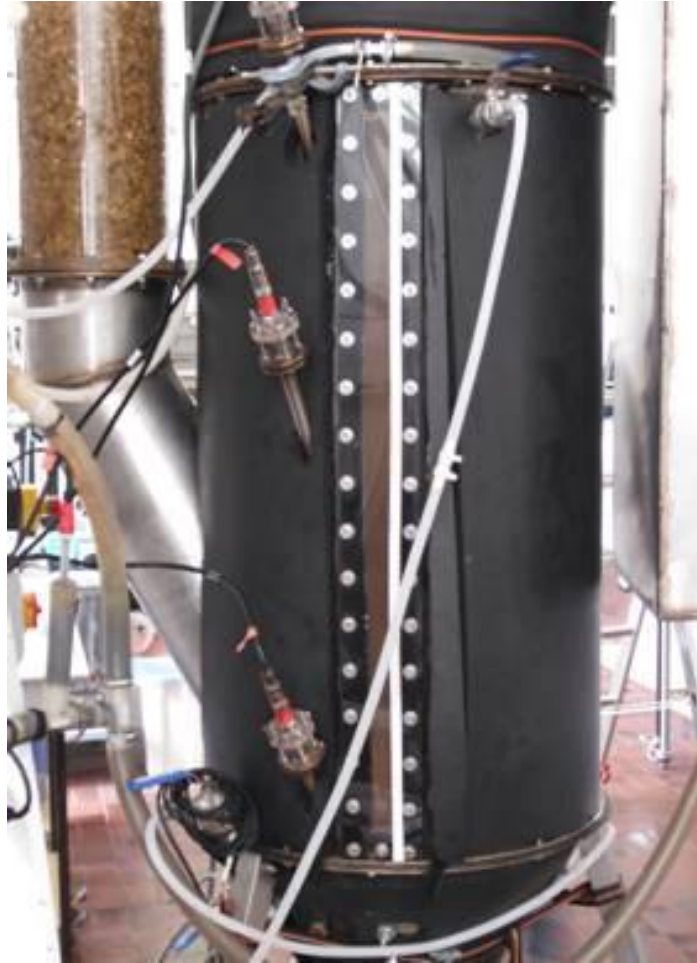
Abb. 6: Mittelteil des AFR mit seitlicher Substratzuführung und Sichtfenster
