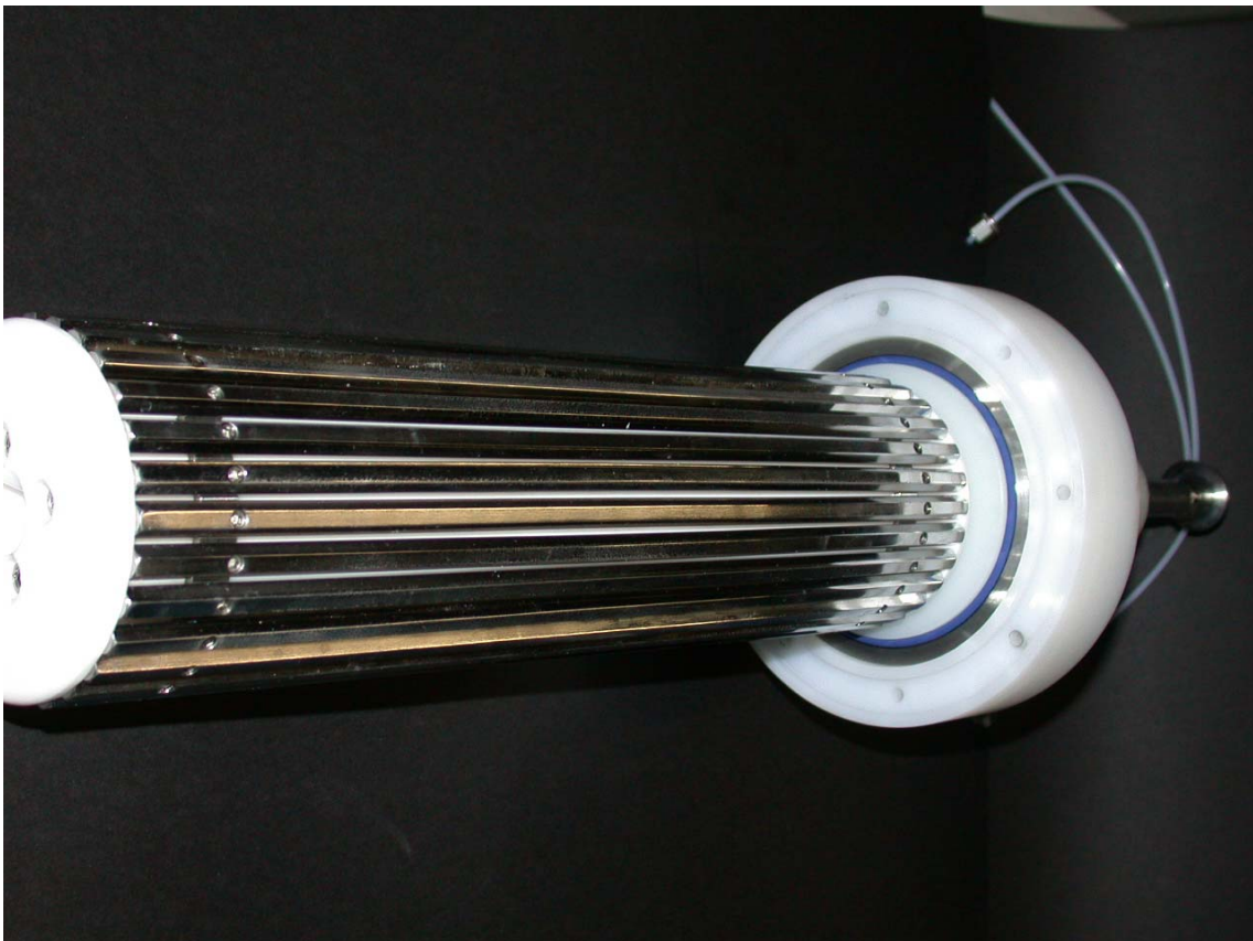
Abbildung 21: Elektrodenkonfiguration des Rotationsreaktors
