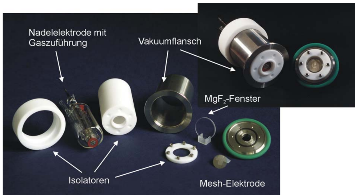
Abbildung 30: Fotos des VUV-Strahlungsmessreaktors im zerlegten und zusammengebauten Zustand
