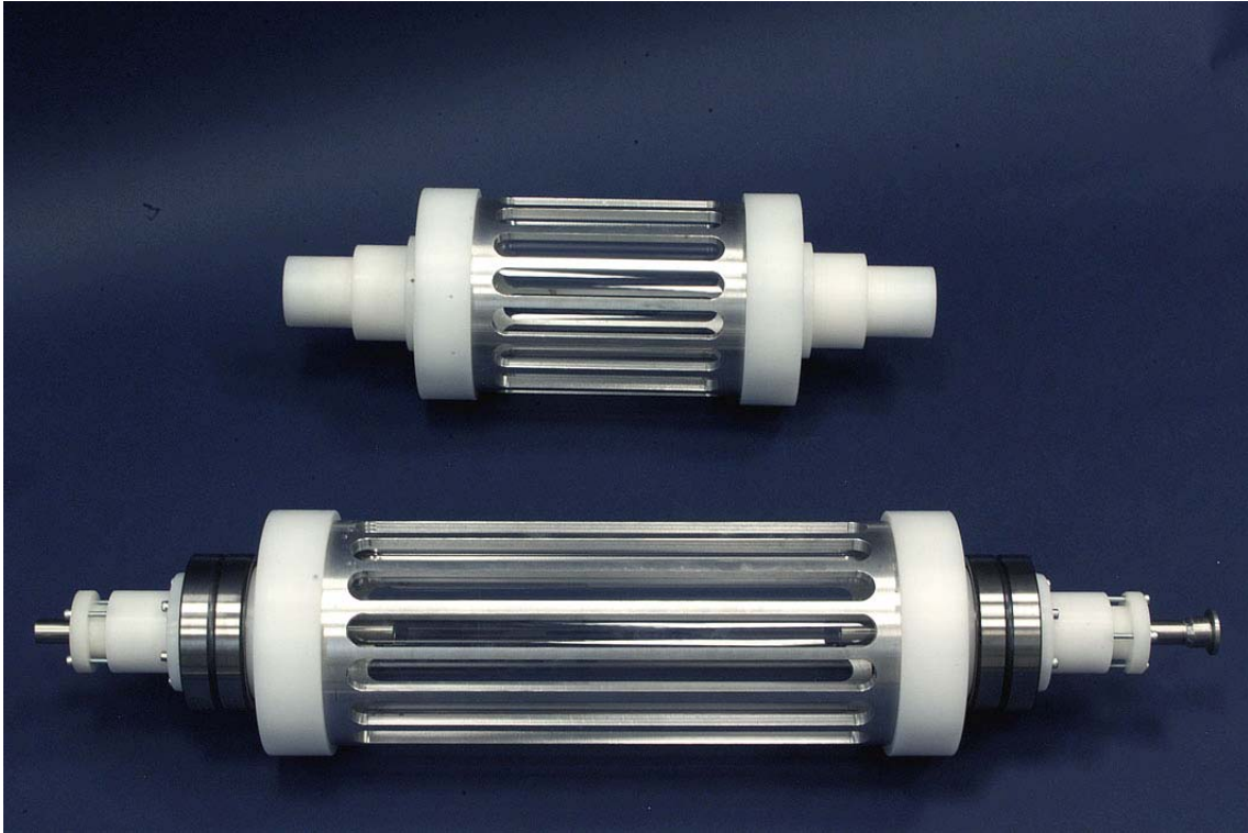
Abbildung 20: Foto der beiden Walzenreaktoren, deutlich ist die Al-Stützkonstruktion sowie die Lagerschalen zu sehen
