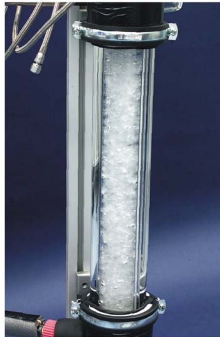
Abbildung 32: Schema des Bubblers, die Füllung des Bubblers besteht aus Wilson-Spiralen
