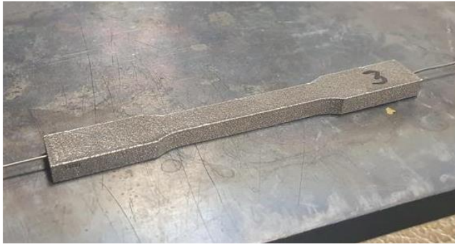
Abbildung 49: Zugprobe mit integrierter Faser auf einer Heizplatte (links), Messung der thermisch induzierten Dehnung der Zugprobe (rechts)
