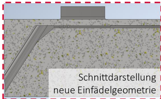
Abbildung 58: Fertigung des Demonstratorbauteils mit komplexer Faserführung. Alte und neue Einfädelgeometrie (links) und verteilung der Faser über die Bauteiloberfläche (rechts).
