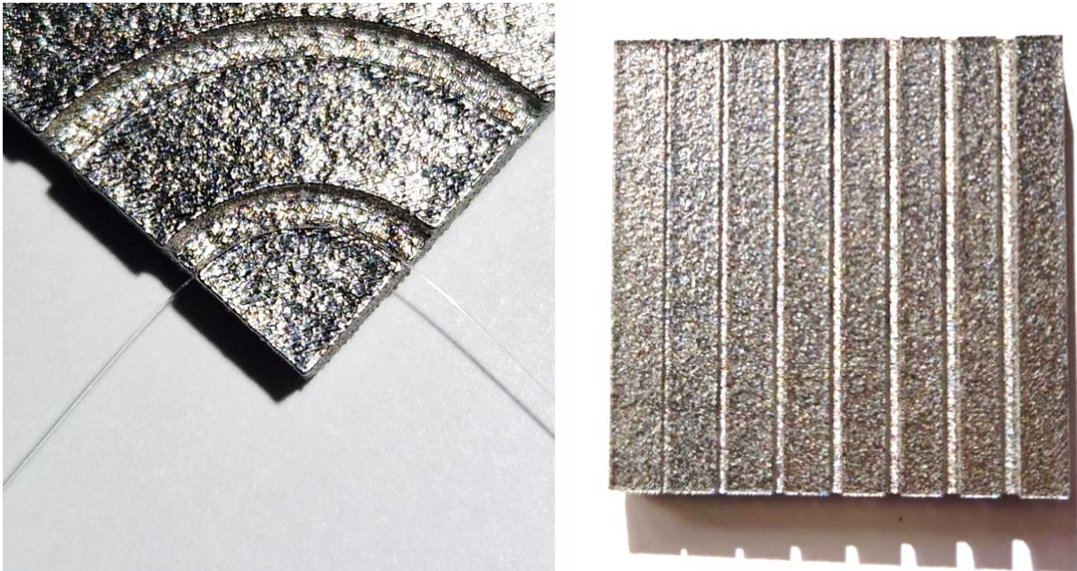
Abbildung 65: Test-Geometrien zur Glasfaseranalyse; Radien-Test (links) Kanal-Durchmesser-Test (rechts).
