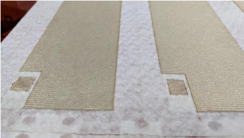
Abbildung 5: Prüfstruktur für leitfähiges Textil gelasert
