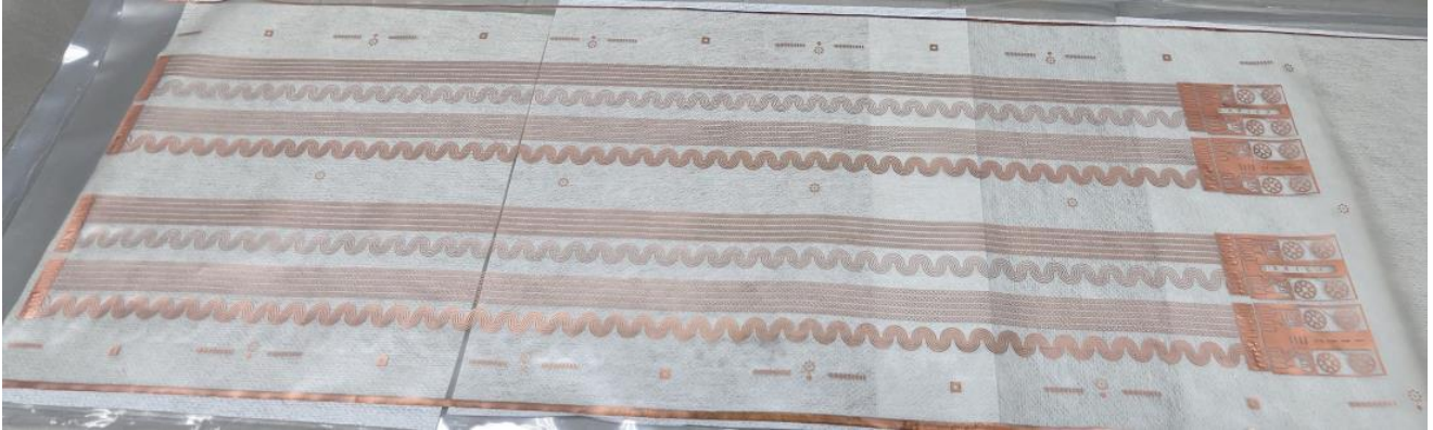
Abbildung 6: Testmuster mit unterschiedlichen mäandernden Strukturen
