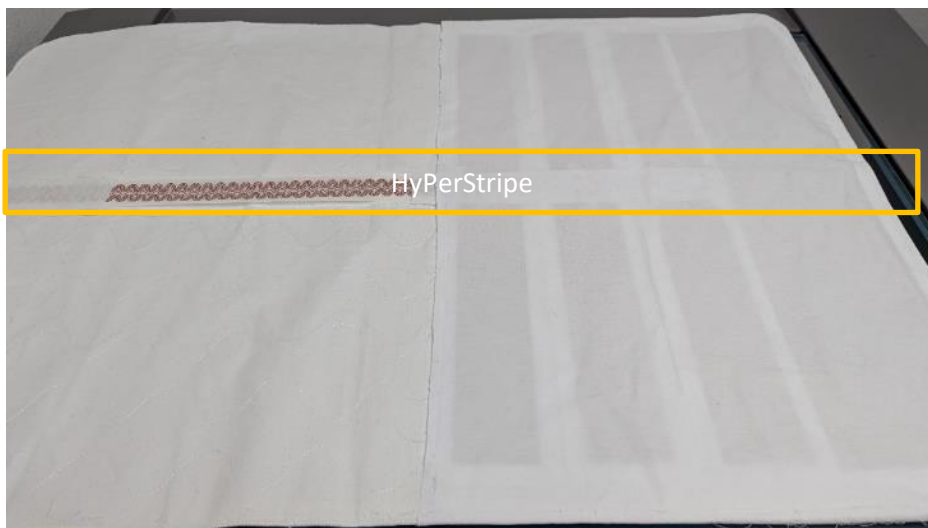
Abbildung 16: Sensorblatt mit TPU HyPerStripe
