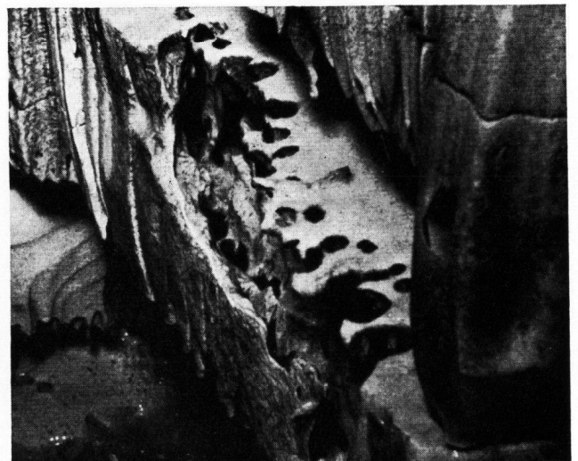
Bild 5. Von Tropfen durch Corhart-Schalen gefressene Löcher.
