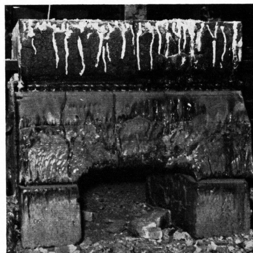
Bild 1. Silika-Flüsse auf Corhart-Material über dem Durchlaß einer Grünglaswanne.
