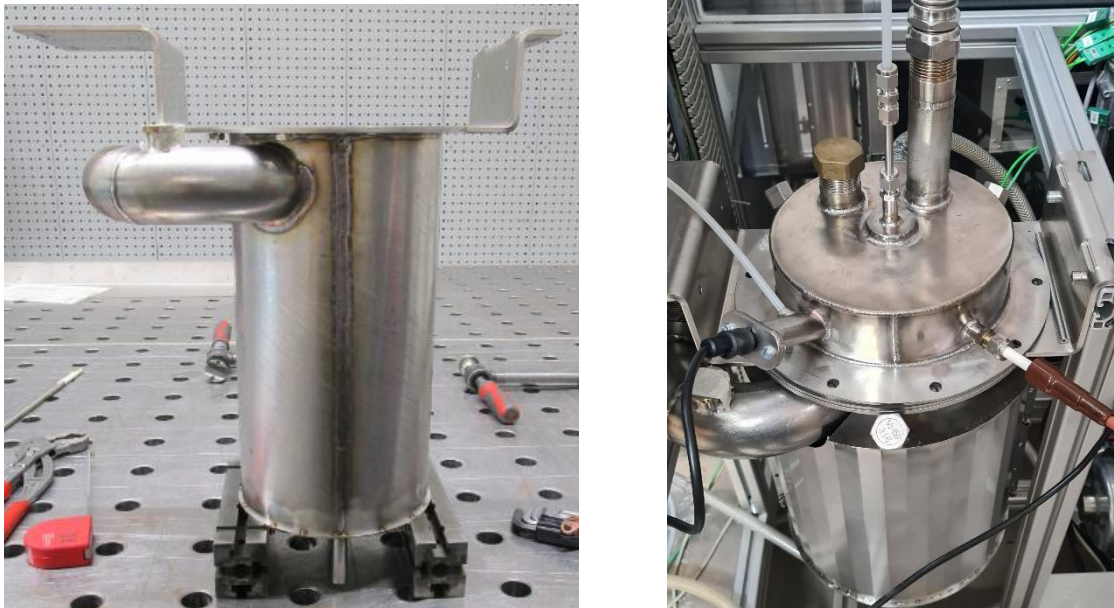
Abbildung 14: H 2 -Spitzenlastbrenner beim Schweißen und auf dem Brennerversuchsstand
