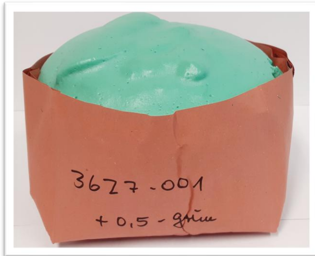
Abbildung 11: Appliance-Hartschaum auf Basis von biobasiertem Anilin aus dem Pilot-Maßstab
