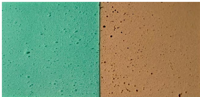
Abbildung 10: links PUR/PIR-Hartschaum (grün eingefärbt; 40 kg/m 3 ) aus biobasiertem MDI, rechts die gleiche Rezeptur mit petrobasiertem MDI
