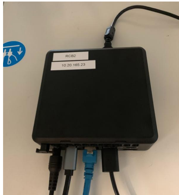
Abbildung 15: Externe Echtzeitsteuerung für die schnelle Integration in verschiedene Robotersysteme
