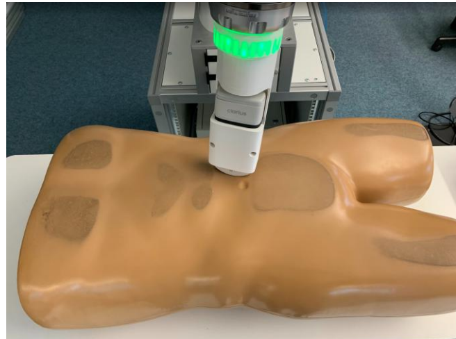
Abbildung 18: Phantom zur Evaluierung der robotergeführten Ultraschallsonde
