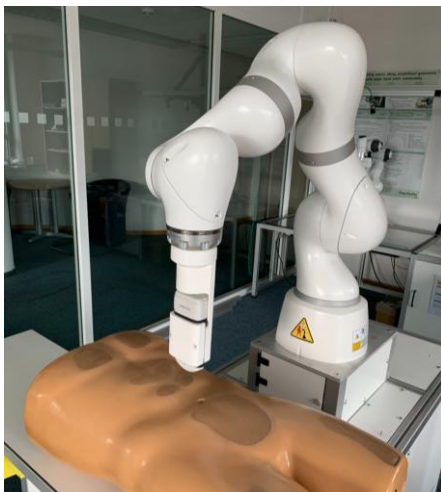
Abbildung 7: Grobpositionierung der vom Roboter geführten Ultraschallsonde über dem Patienten
