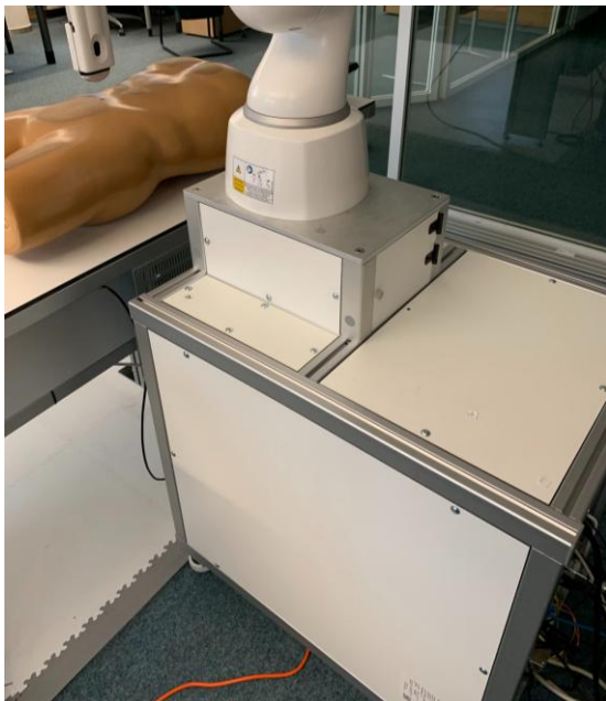
Abbildung 14: Verfahrbarer Trolley für die schnelle Integration in ein OP
