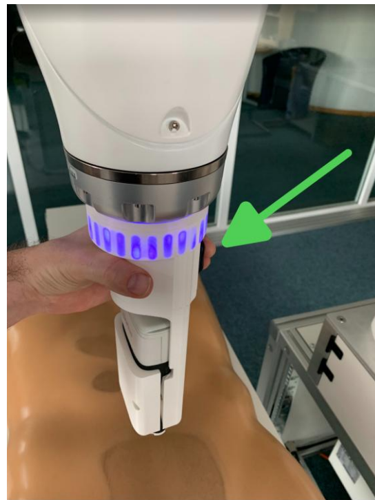
Abbildung 12: Bestätigung der Moduswahl durch Drücken des Zustimmungstasters
