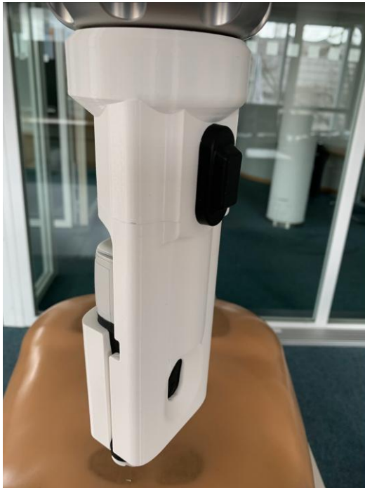
Abbildung 9: Endeffektor des Roboters mit Zustimmungsschalter
