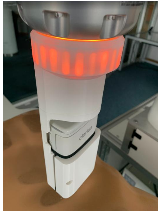
Abbildung 10: Statusanzeige in Form eines LED Rings am Endeffektor des Roboters
