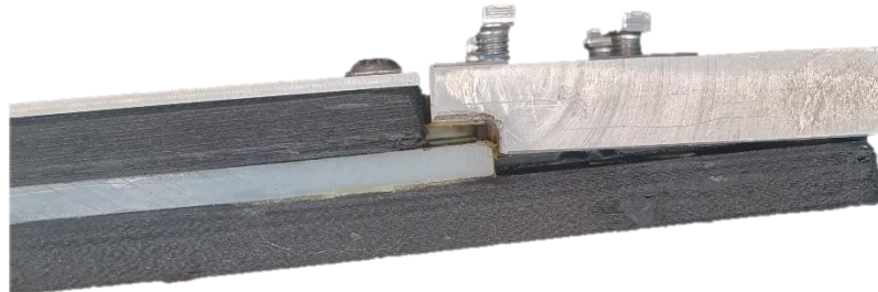
Abbildung 51: Bild der verbogenen Batteriekasten-Anbindungsseite nach dem Belastungsprüfstand
