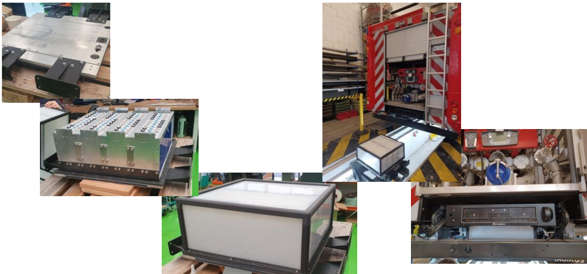
Abbildung 46: Bilder von der Integration der Batteriemodule in den Batteriekasten und dem Einbau des Batteriesystems ins Erprobungsfahrzeug
