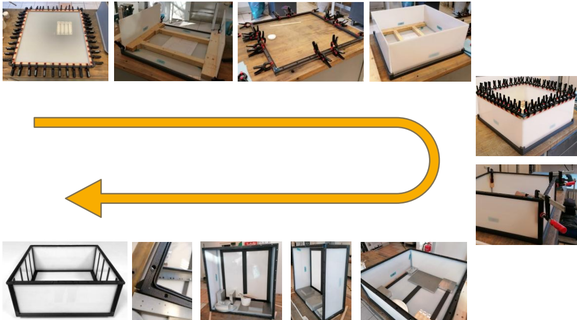
Abbildung 44: Aufbau der „Trog“-Seite des ersten Batteriekastendemonstrators
