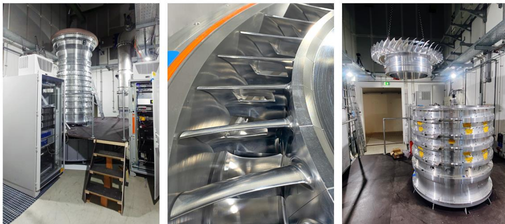
Abbildung 50: Umbau des FRANCC-Prüfstands auf die DRIVER-Beschaukelung
