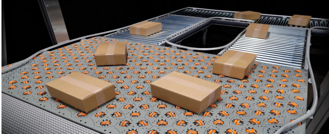
Abbildung 1: Omnidirektionales Transportsystem celluveyor der Firma cellumation GmbH.
