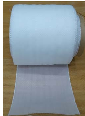
(3) PBS-Gewebe STFI, Leinwandbindung (Bio ELAN A005)
