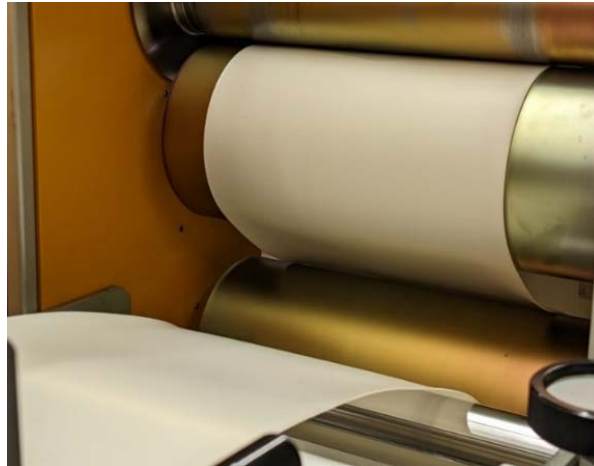
Abbildung 5: Flachfolienextrusion (Dicke ca. 980 \mu m)
