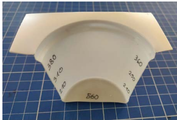
Abbildung 6: Wanddickenprofil Becher aus „A105S“
