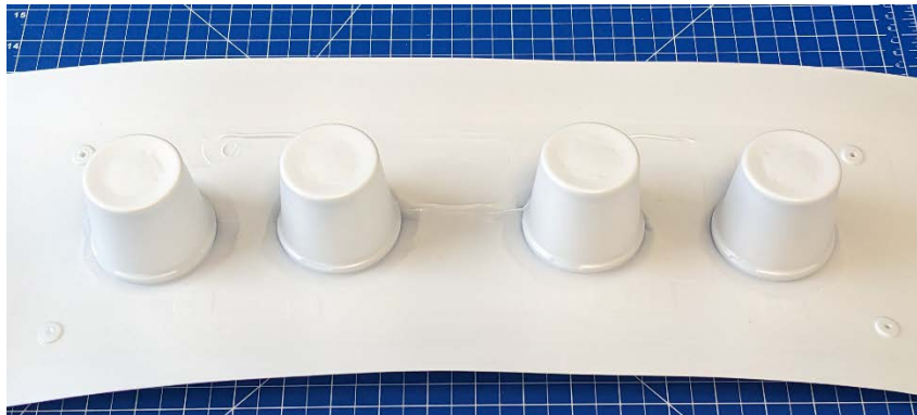
Abbildung 4: Aus TZ-1.1 thermogeformte Joghurtbecher
