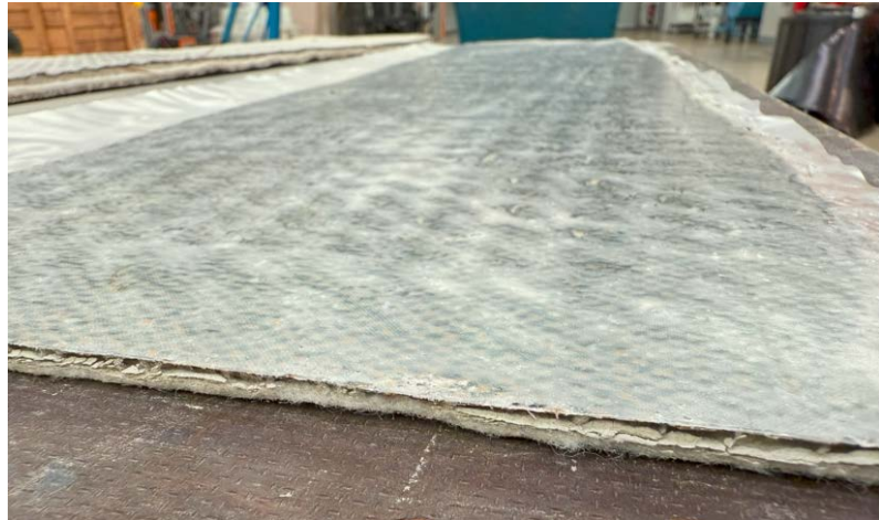
Abbildung 25: Tondichtungsbahn – Demonstrator (KFK_872), Länge 1000 mm, Breite 200 mm, Höhe 5 mm
