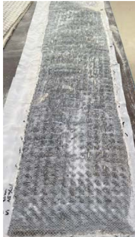
Abbildung 25: Tondichtungsbahn – Demonstrator (KFK_872), Länge 1000 mm, Breite 200 mm, Höhe 5 mm
