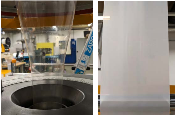
Abbildung 2: PAZ-29 (extrahiert) (links: Schmelzaustritt an der Ringdüse / rechts: doppelt flachgelegte Folie)
