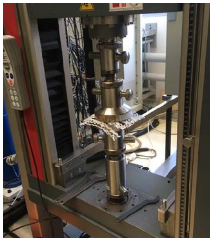
Abbildung 18: Beispiel statischer Drucktest an Wirrgelege (links), geprüftes Wirrgelege (rechts)
