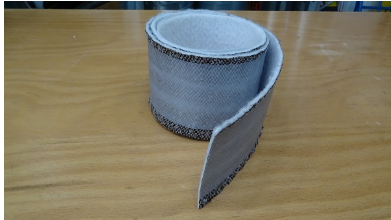
Abbildung 23: PLA-/Gewebe/Vlies vernadelt nach dem Coatingprozess
