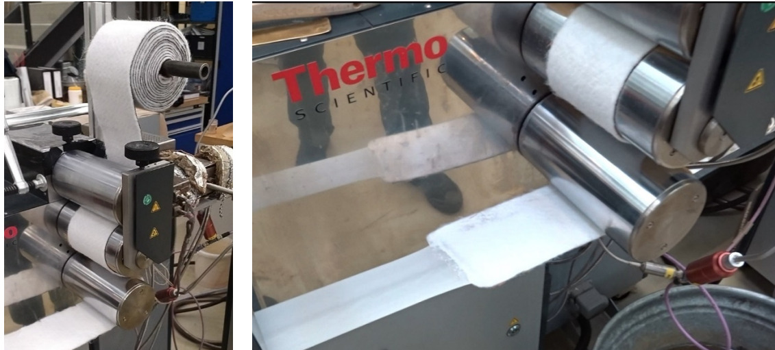
Abbildung 22: Beschichtungsprozess Gewebe mit Blend-Folie
