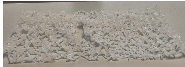
Abbildung 17: Beispiel Fallbolzentest an Wirrgelege (links), geprüftes Wirrgelege (rechts)
