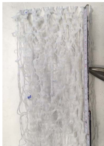
Abbildung 18: Beispiel statischer Drucktest an Wirrgelege (links), geprüftes Wirrgelege (rechts)
