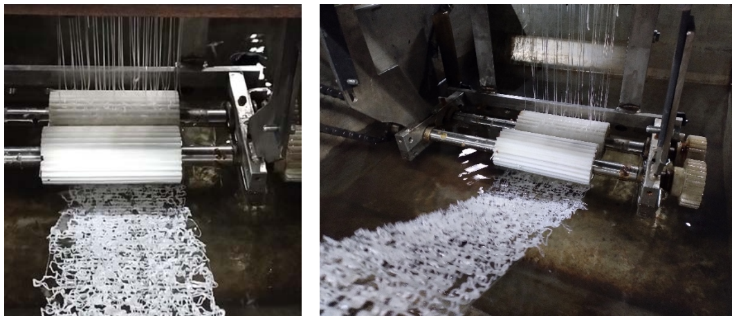
Abbildung 19: Testversuch Wirrgelegeherstellung (Breite ca. 20cm) der Fraunhofer IMWS-Blends bei Projektpartner Naue
