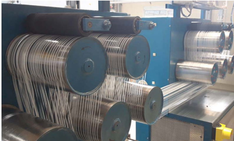
Abbildung 3 Geschnittene Bändchen aus einer PBS-Flachfolie
