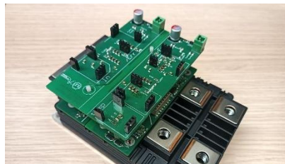
Abbildung 10: Gatetreiber für eine einzelne Halbbrücke (links) und zwei parallele Halbbrücken (rechts). Die oberen Leiterplatten tragen die Vorstufe und die unteren Leiterplatten die Endstufen der Treiber.
