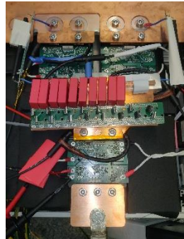
Abbildung 11: Phasenbaustein der 3-Level ANPC Topologie mit zusätzlichem Überspannungsbegrenzungsnetzwerk.
