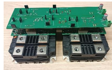
Abbildung 10: Gatetreiber für eine einzelne Halbbrücke (links) und zwei parallele Halbbrücken (rechts). Die oberen Leiterplatten tragen die Vorstufe und die unteren Leiterplatten die Endstufen der Treiber.
