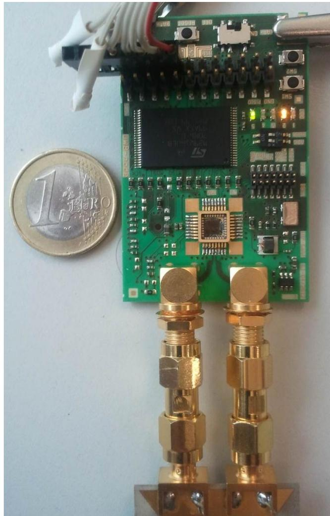
Abbildung 18: Erster Sensorknoten mit vollständig in Deutschland gefertigter Hardware und Software, bestehend aus einem 16-Bit-Mikrocontroller und einem UWB-Radiomodul
