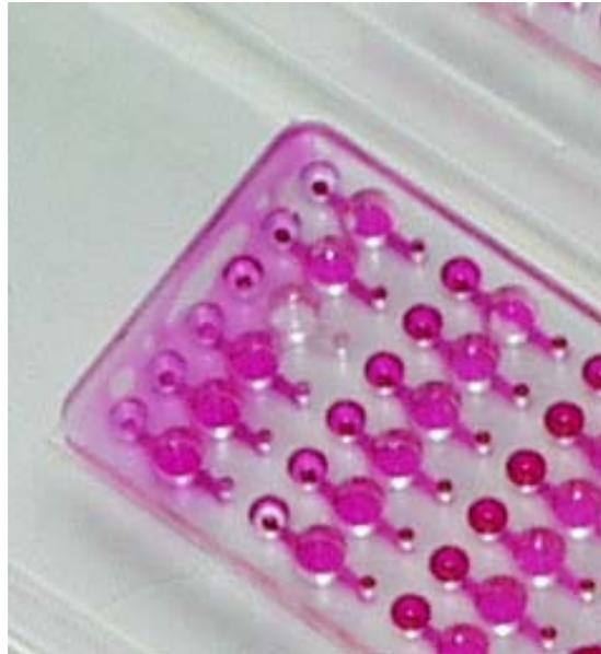
Abb. 21: Chip nach Befülltest mit farbstoffhaltiger Detergens-Lösung.
