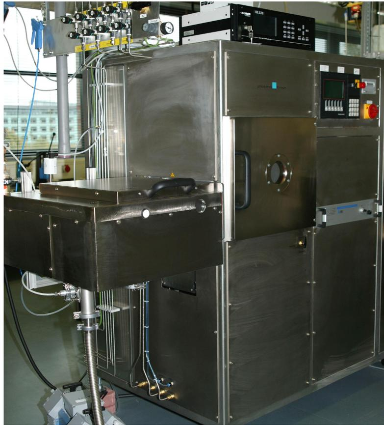
Abb. 9: Feinvakuum-Plasmaprozessor V55 GS (PlasmaFinish Schwedt/O.)
