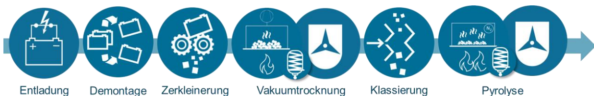
Abbildung 1: Recycling-Prozesskette im Projekt LOWVOLMON. Hier: Klassierung vor der Pyrolyse dargestellt.
