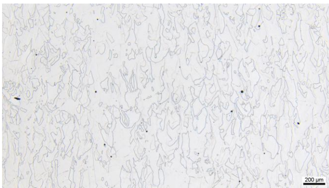
Abbildung 10 Ti10-2-3 as-built 200°C
