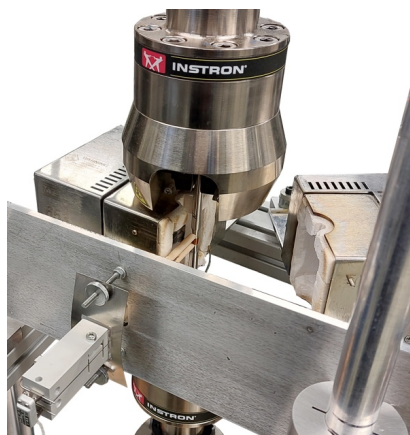
Abb. 22: Versuchsaufbau für Zugversuche an der Probengeometrie für Proben aus der Rohrleitungskomponente
