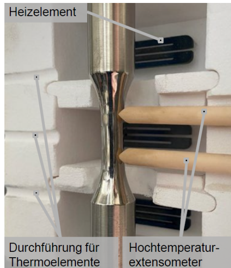
Abb. 34: Versuchsaufbau für Ermüdungsversuche bei 240 und 300 °C mit Instrumentierung des 3-Zonen-Ofensystems
