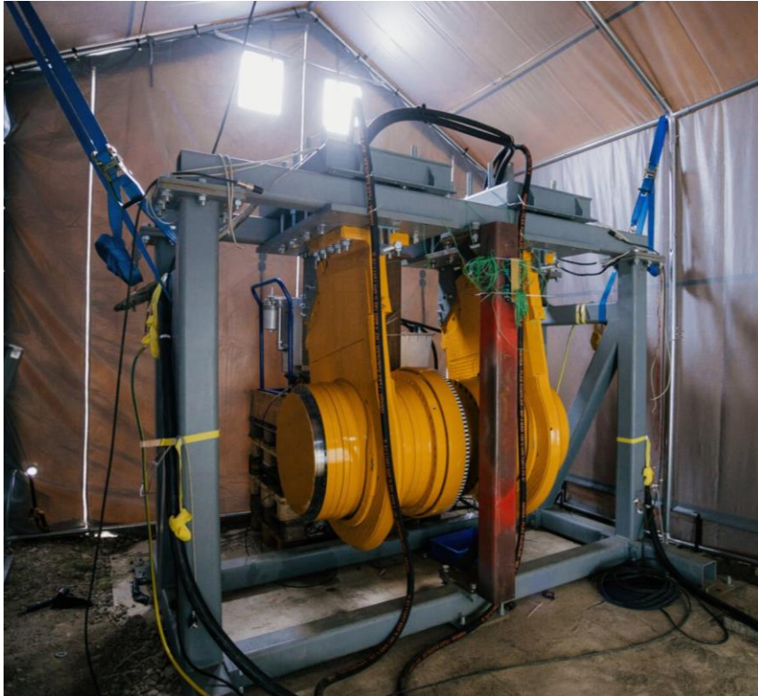
Abbildung 10: Aufbau des Back-to-Back-Getriebetest
