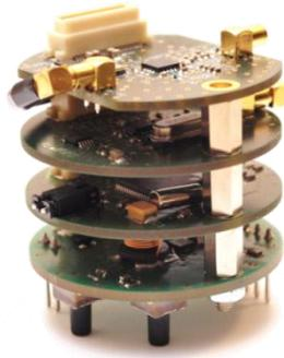
**Abbildung 10: IHPStack mit vier Modulen (Power, Controller, Transceiver und Amplifier)**
