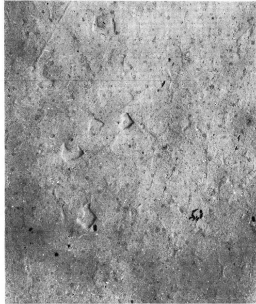
Bild 11. Probe SM 463. Polierte Oberfläche. Pt + C-Aufdampf- Direktabdruck. Vergr. 8000fach.
