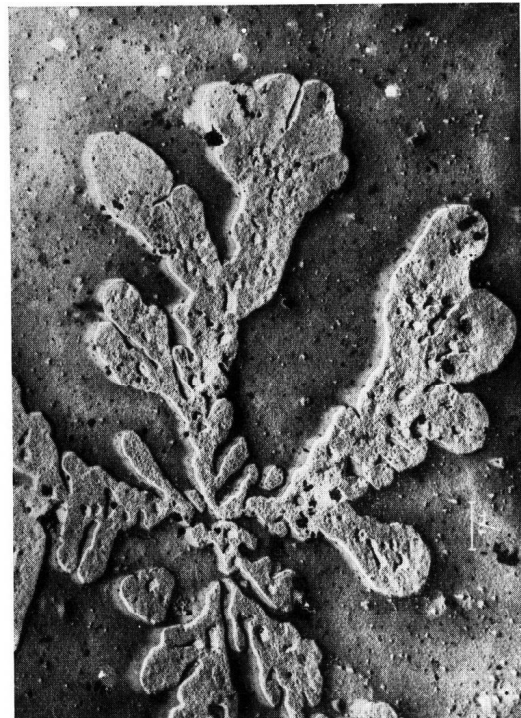
Bild 6. Natron-Kalk-Glas. 2 min in 20%iger HF geätzt. Vergr. 6000fach. (aus BEYERSDORFER [11]).
