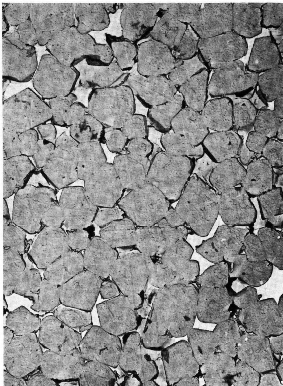
Bild 14. Probe SM 463. Polierte Oberfläche. 10 s in 1%iger HF geätzt. Pt + C-Aufdampf-Direktabdruck. Vergr. 8000fach.
