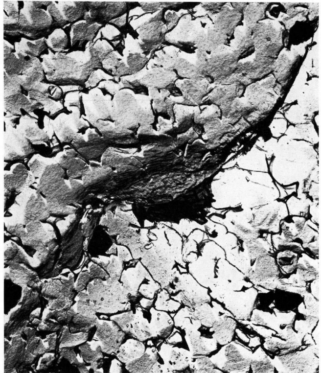
Bild 19. Probe SM 463. Bruchfläche. 10 s in 1%iger HF geätzt. Triafol-Doppelabdruck. Vergr. 10000fach.
