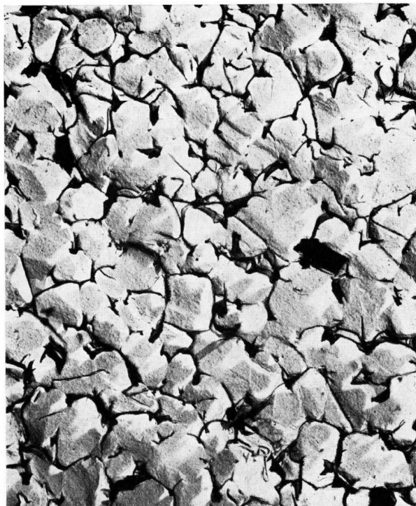
Bild 18. Probe SM 463. Bruchfläche. 10 s in 1%iger HF geätzt. Triafol-Doppelabdruck. Vergr. 10000fach.
