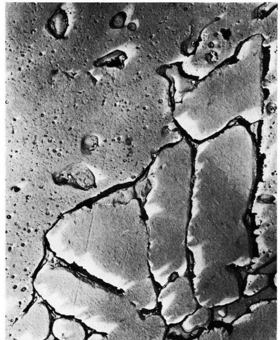
Bild 9. Probe SM 441. Polierte Oberfläche 10 s in 1%iger HF geätzt. Triafol-Doppelabdruck. Vergr. 8000fach.
