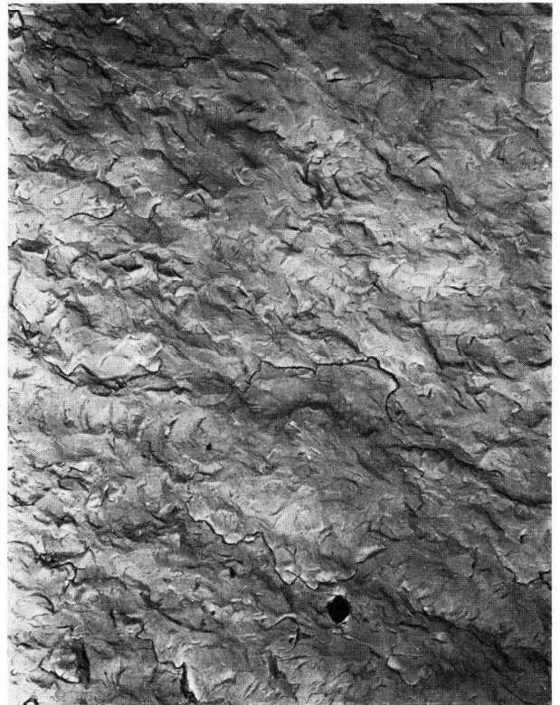
Bild 15. Probe SM 463. Bruchfläche. Triafol-Doppelabdruck. Vergr. 2500fach.
