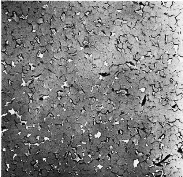
Bild 13. Probe SM 463. Polierte Oberfläche. 10 s in 1%iger HF geätzt. Pt + C-Aufdampf-Direktabdruck. Vergr. 2500fach.
