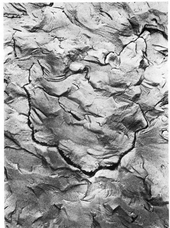
Bild 16. Probe SM 463. Bruchfläche. Triafol-Doppelabdruck. Vergr. 8000fach.
