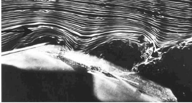
Abb. 2.4: Scherschicht über einer Klappe, angeregt durch einen oszillierenden Vorflügel (flaperon) nach [8]
