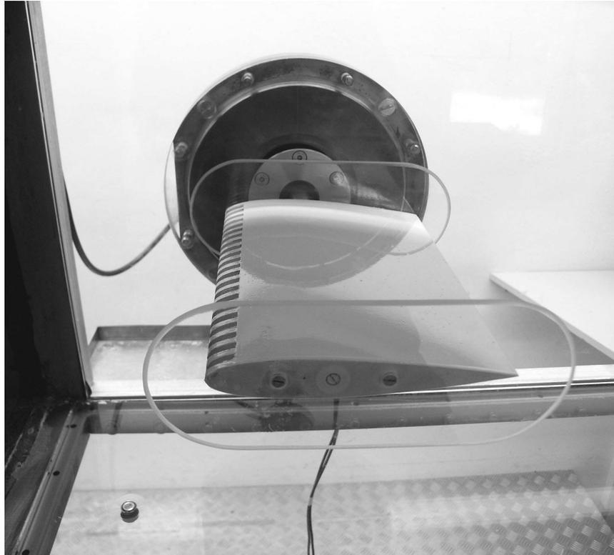
Abb. 3.11: Bild NACA 0015 in der Messstrecke, im Hintergrund Rückansicht der Verdrehrichtung und des Radialwellendichtrings.
