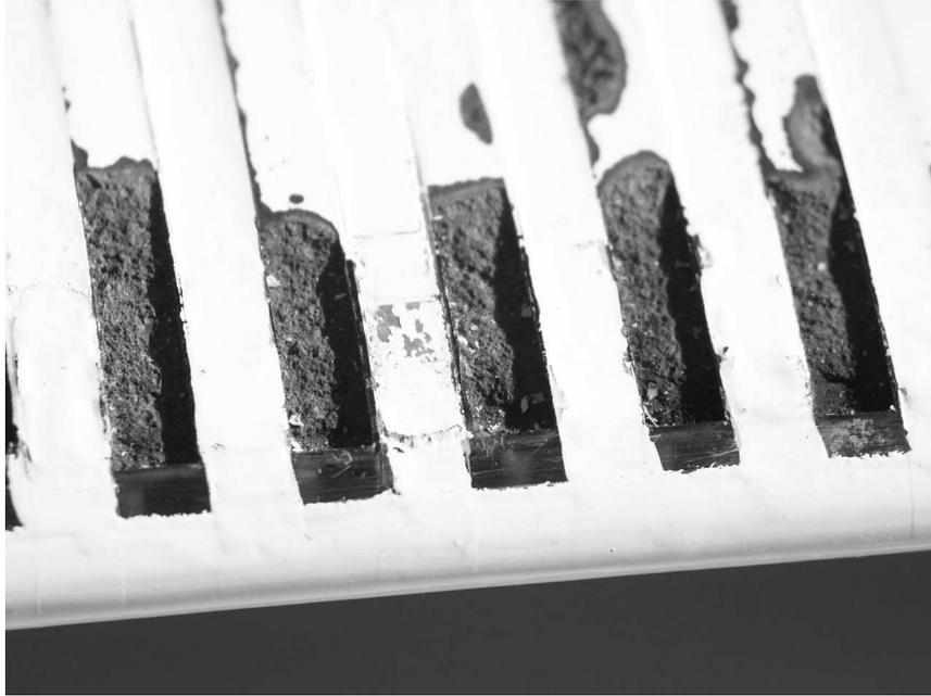
Abb. 3.4: Detail der Profilverkante nach Versuchsende, starke Korrosionsspuren an den Elektroden. Vergrösserte Darstellung im Massstab ca. 2:1.
