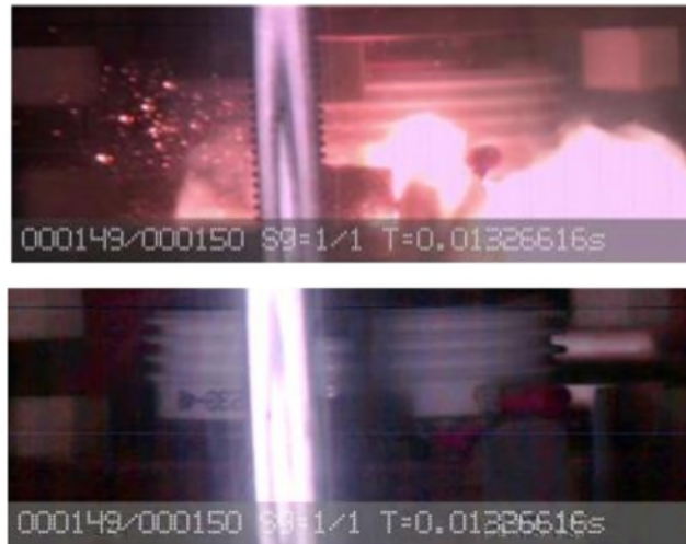
Abbildung 12: DUTs mit Plasma-Austritt im Rahmen der Kurzschlussprüfung © Technische Universität Dresden
