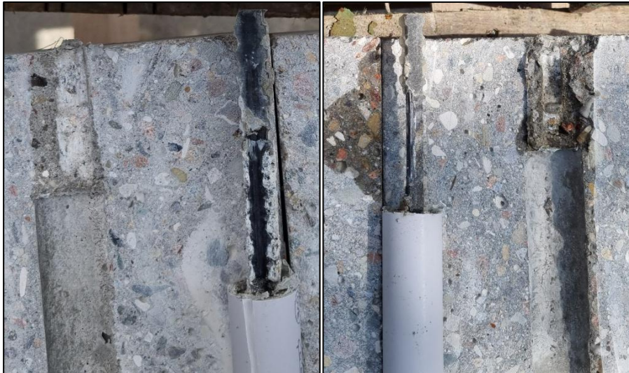
Abbildung 5: Aufgesägter Probekörper mit Carbonbewehrung DBS-C Abscheren der Betonkonsole (links) und Abscheren der Profilierung des Stabes (rechts)
