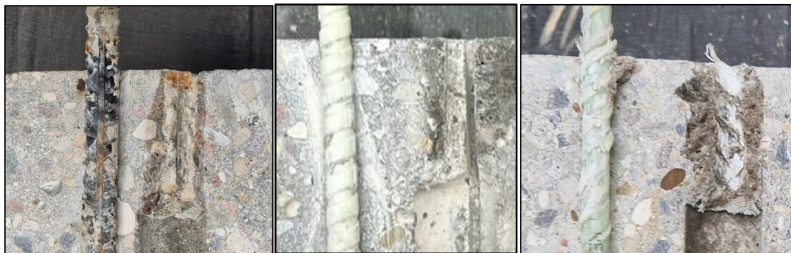
Abbildung 4: Aufgesägte Probekörper mit Betonstahl (links), Schöck Combar (mitte) und Solidian RRE (rechts)
