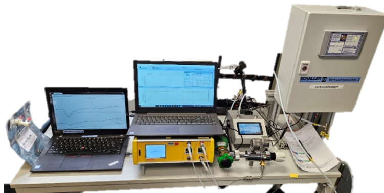
Abbildung 30: Versuchsaufbau (Setup) mit GasMOS- H2 Prototyp (rechts) am Einzylinderprüfstand des LKV
