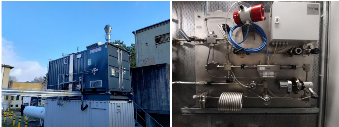
Abbildung 73: HD-Brenngasverdichter (l.) und Druckregelstrecke im Prüfstand (r.)
