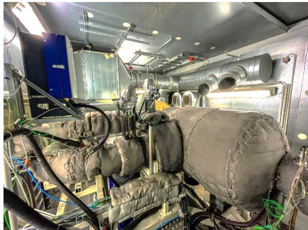
Abbildung 38: Installierte Abgasstrecke mit Isolierung
