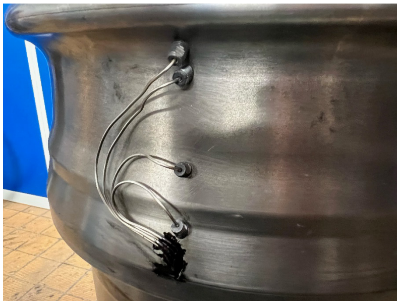
Abbildung 4: Laufbuchse bestückt mit Thermoelementen
