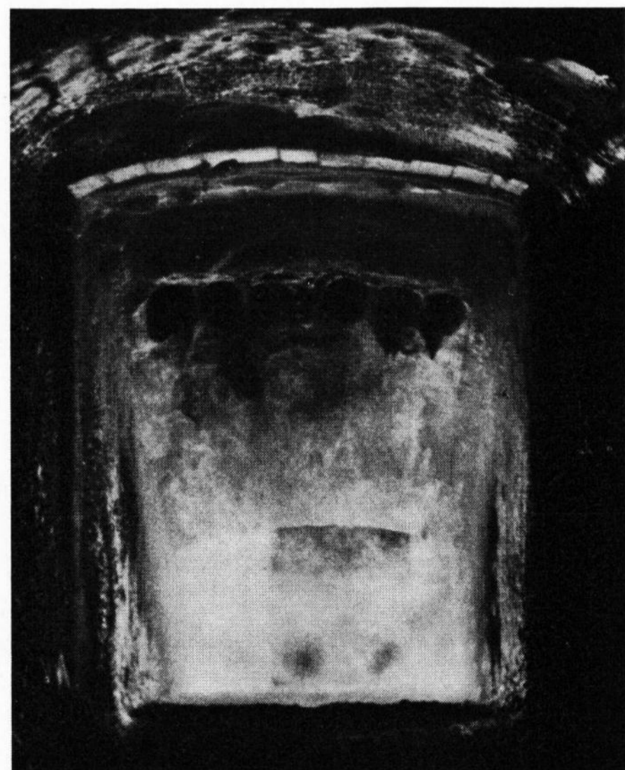
Bild 13. Gleiche Sicht wie Bild 11, aber mit hohem Primärluft-Zusatz.
