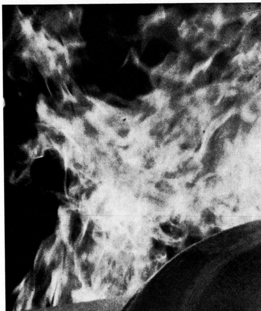
Bild 8. Flamme in einem Einhafen-Ofen über dem Hafen.
