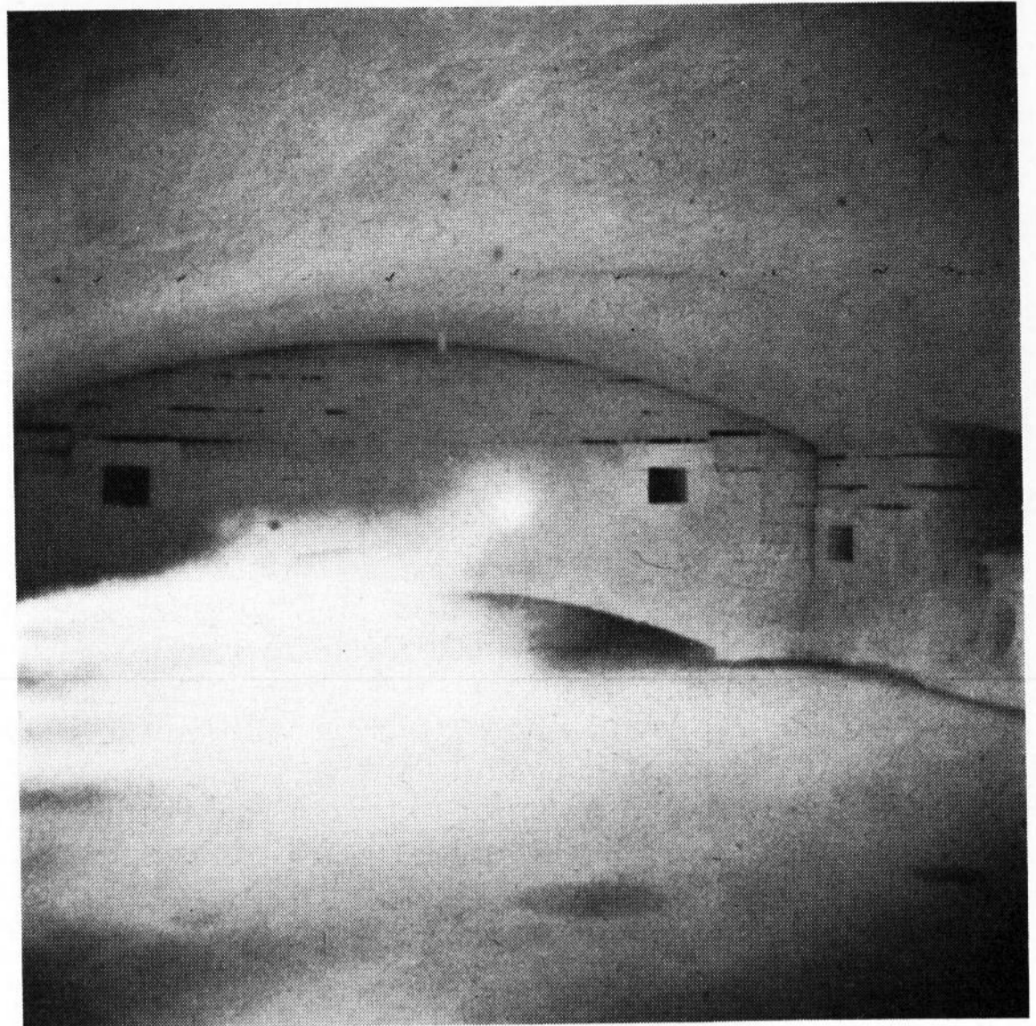
Bild 17. Mit Leichtöl beheizte Wanne.
