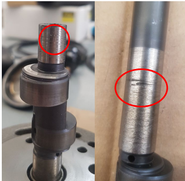
Abbildung 1: Gleitlager des defekten Verdichters. Erkennbar sind die sog. Fresser (rote Markierungen), welche auf Schmierungsprobleme hindeuten.
