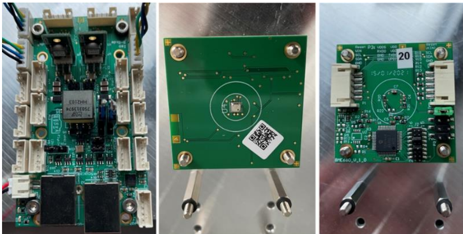
Abbildung 3: Die Control Unit verbindet die Klickboards mit einem Computer zum Host (links). Vorderseite eines Klickboards mit Sensor (Mitte), Rückseite mit diskreten Bauteilen (rechts).
