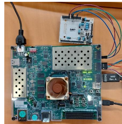
Abbildung 2: Links: Host-SoC mit Root-of-Trust-SoC, Rechts: Host-SoC mit NXP Secure Element
