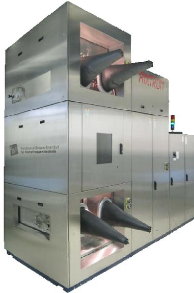
**Abb. 7** Neue vertikale HVPE-Anlage mit dem ca. 4 m hohen Reaktorturm, der substratseitig (oben) und quellenseitig (unten) mit stickstoffgespülten Handschuhboxen ausgerüstet ist.
