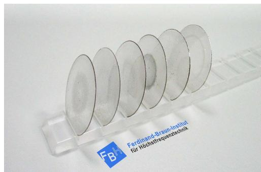
Abb. 4 Freistehende GaN-Wafer mit 2 Zoll Durchmesser aus dem WSiN-ELOG-Prozess.
