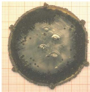
**Abb. 6** Foto eines bei 200 hPa gewachsenen, 3,5 mm dicken GaN-Boules.
