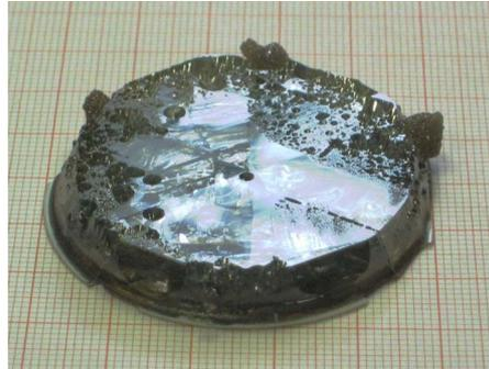
**Abb. 9** Foto eines 2“ GaN-Boules mit einer Dicke von 6,3 mm, der mit 450  $\mu\text{m}/\text{h}$  in 14 Stunden gewachsen wurde. Die Versetzungsdichte an der Oberfläche ist  $6 \times 10^5 \text{ cm}^{-2}$ .
