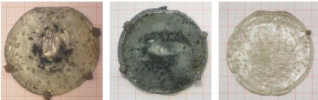
**Abb. 8** Fotos freistehender 2" GaN-Boules mit Dicken von 3,7 mm (links), 3,9 mm (mitte) und 2,6 mm (rechts). Der letzte Boule rechts hat keine internen Rissnetze.
