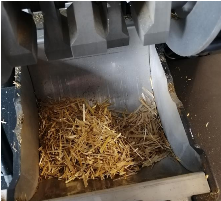
Abbildung 24: Stroh von Betrieb B1 nach 2 x 10 s Hammermühle (ohne Sieb → Batchbetrieb)
