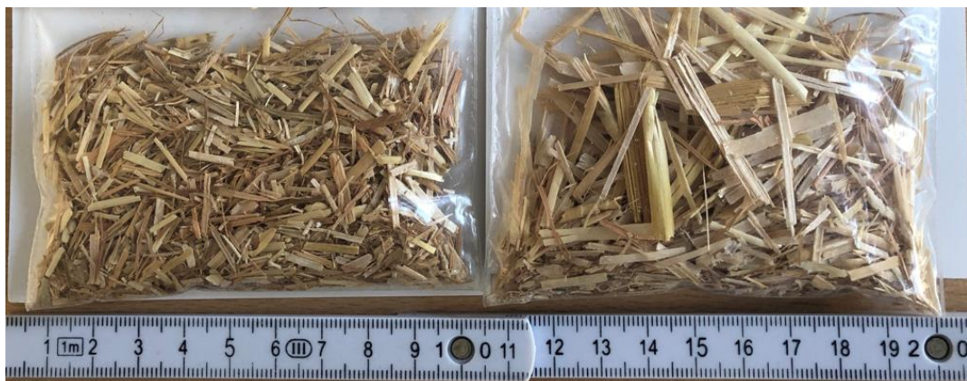
Abbildung 34: Stroh nach Teagle Strohmühle Tomahawk (links: C12, rechts: Dual Chop)
