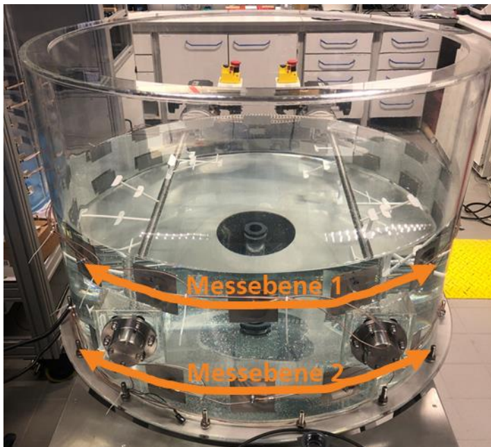
Abbildung 52: Tomographie-Reaktor mit installierter Mess- und Rührtechnik
