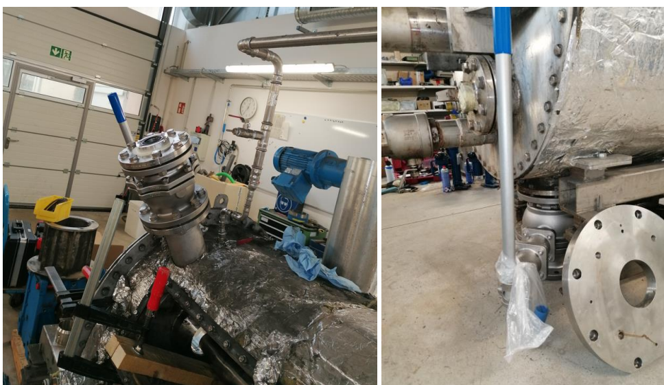
Abbildung 71: Fermenter in der Werkstatt bei UIT mit neuem Anschluss für die Gölledosierung und Probenahmestutzen (rechts)
