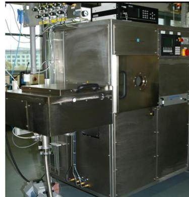
Abb. 3.24: PlasmaFinish Niederdruckreaktor (Schwedt/ O.) im RF-Plasma
