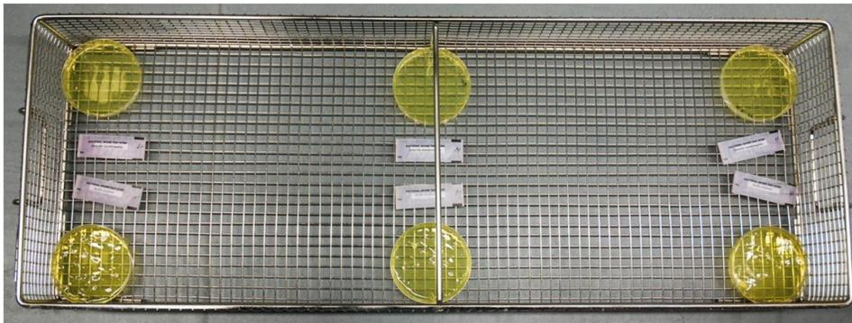
Abb. 3.50: Platzierung der Agarplatten und Teststreifen während des Behandlungsprozesses im Demonstrator 2.
