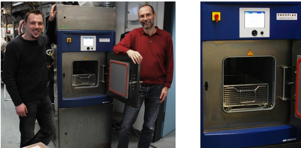
Abb. 3.37: Darstellung des Demonstrators 2: Reaktorvolumen 145 l, Nutzvolumen 90 l, Mikrowellenleistung Plasmagenerator 1-2 kW, Gasverbrauch 16 slm Pressluft
