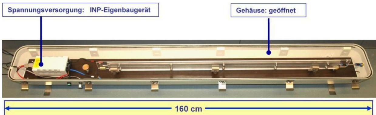
Abb. 3.26: Schlauch-Treater mit DBE-Anordnung als Referenzentladung
