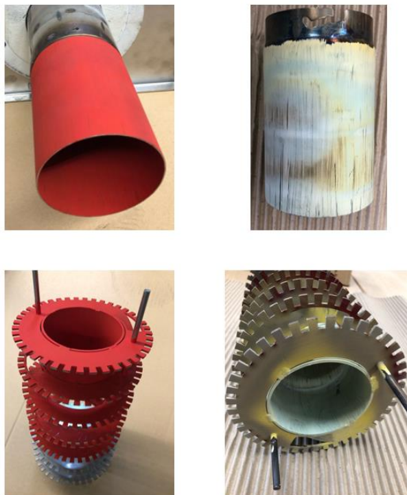
Abbildung 11: Vorher (links) - Nachher (rechts) Gegenüberstellung der Komponenten in der Brennkammer nach dem Brennvorgang. Die Farbänderungen lassen auf die maximal vorliegenden Temperaturen schließen.
