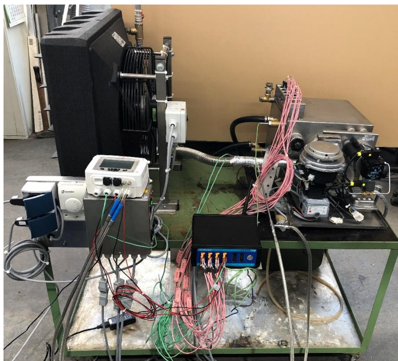
Abbildung 10: Teststand zur Ermittlung verschiedener Temperaturen am Heizgerät. Ein einstellbarer Heizlüfter (links) sorgt für variable Wärmeabnahme, das Heizgerät (rechts) kann mit bis zu 20 Sensoren bestückt werden, um die verschiedenen auftretenden Temperaturen zu messen. Über ein Prantl-Rohr, welches vom Projektpartner ISA zur Verfügung gestellt wurde, können außerdem Geschwindigkeit und Temperatur des Abgases gemessen werden.
