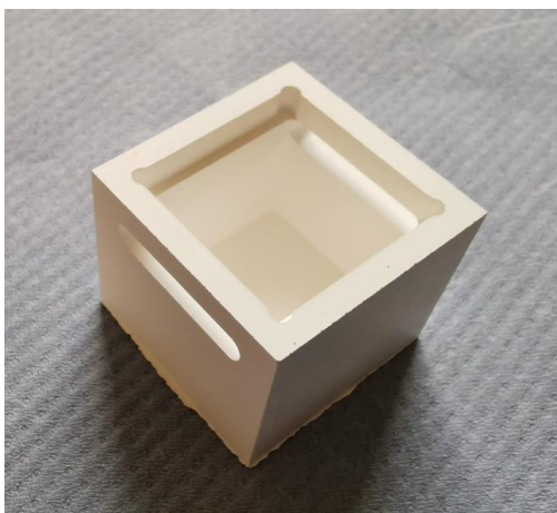
Abbildung 1: Vollkeramisches Gehäuse im Grünzustand aus einem Block gefräst
