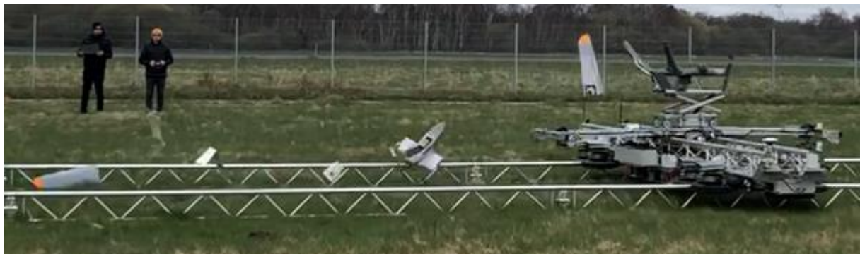
Abbildung 3: Kollision Start-Lande-System mit S180MkII
