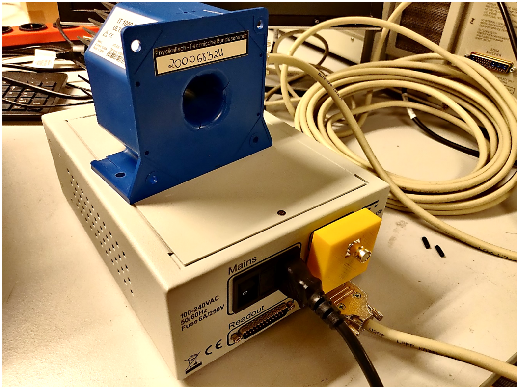
Abbildung 2.18: Nullflusswandler mit der Spannungsquelle und dem Messwiderstand
