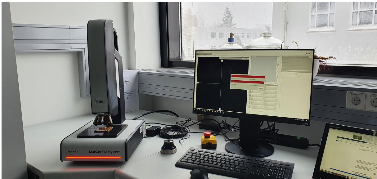
Abbildung 2.22: Links: Hochdurchsatzprofilometer: Konfokalmikroskop; Rechts: Steuer- und Auswerte-PC
