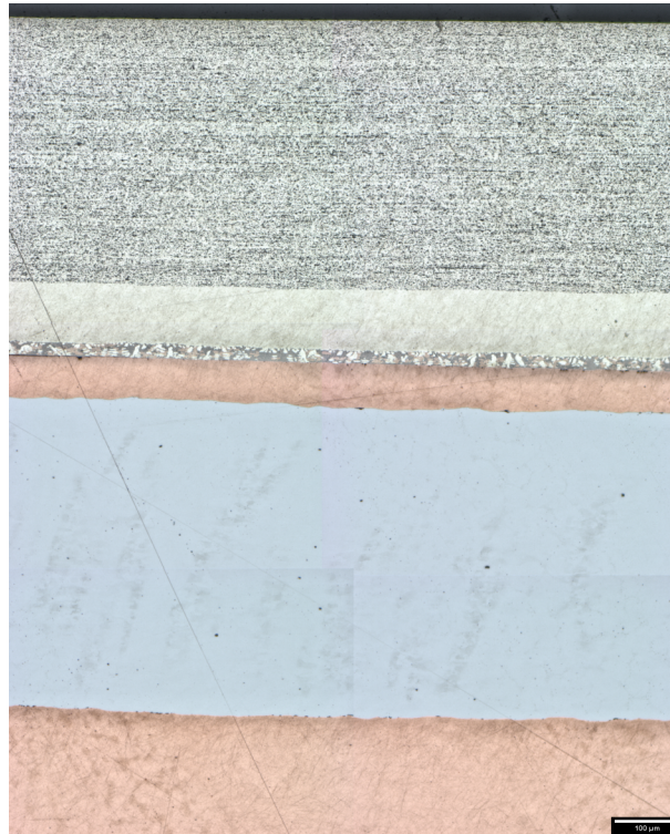
Abbildung 2.1: Lichtmikroskopische Aufnahme des Querschliffs eines Kontaktträgers. Beschreibung von oben nach unten: Ag/SnO 2 88/12-Werkstoff, Ag-Zwischenschicht, Bindenaht (Lot), Cu-Schicht, Fe-Kern, Cu-Träger. (Maßstabsbalken = 100 µm)
