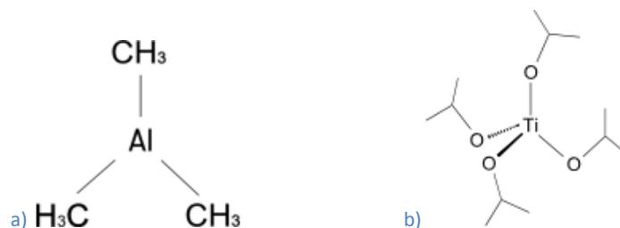
Abb. 12: ALD-Precursoren a) TMA für  $\text{Al}_2\text{O}_3$ ; b) TiIP für  $\text{TiO}_2$
