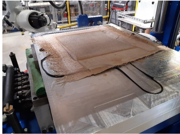
Abbildung 13 Spaltbildung am Rand aufgrund Fixierung des Gewebes durch vernähen, so dass kein Verschieben der beiden Gewebelagen gegeneinander möglich war
