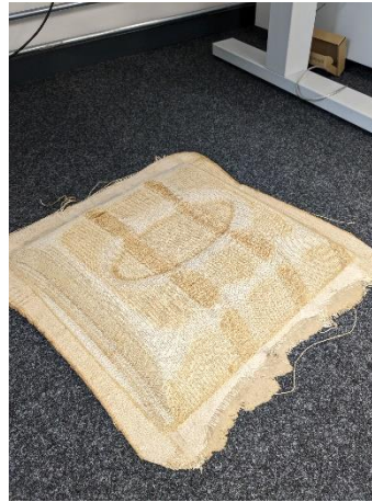
Abbildung 14 Geschäumtes Abstandsgewebe Versuch 1 nach Trocknung
