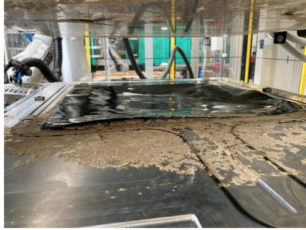
Abbildung 11 Aus der Kavität gepresster Holzschaum aufgrund zu spätem Schließens des Werkzeugs
