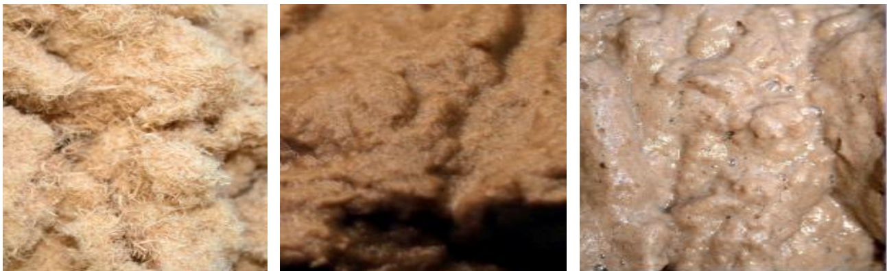
Abbildung 8: Verschiedene Stufen der Holzschlammherstellung. (von links nach rechts) TMP-Faser, Faserschleim und geschäumte Fasersuspension.
