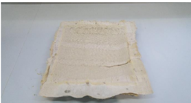
Abbildung 25 Geschäumtes Abstandsgewebe Versuch 13 nach Trocknung
