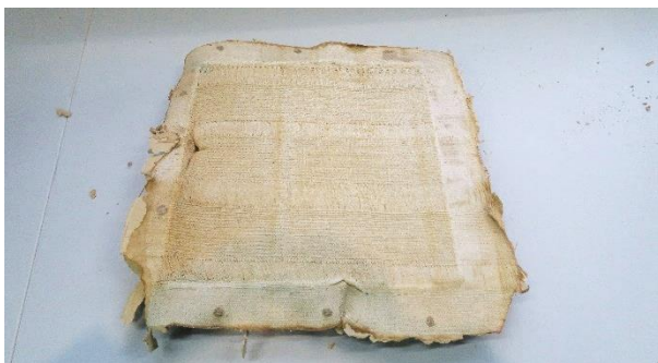
Abbildung 30 Geschäumtes Abstandsgewebe Versuch 18 nach Trocknung
