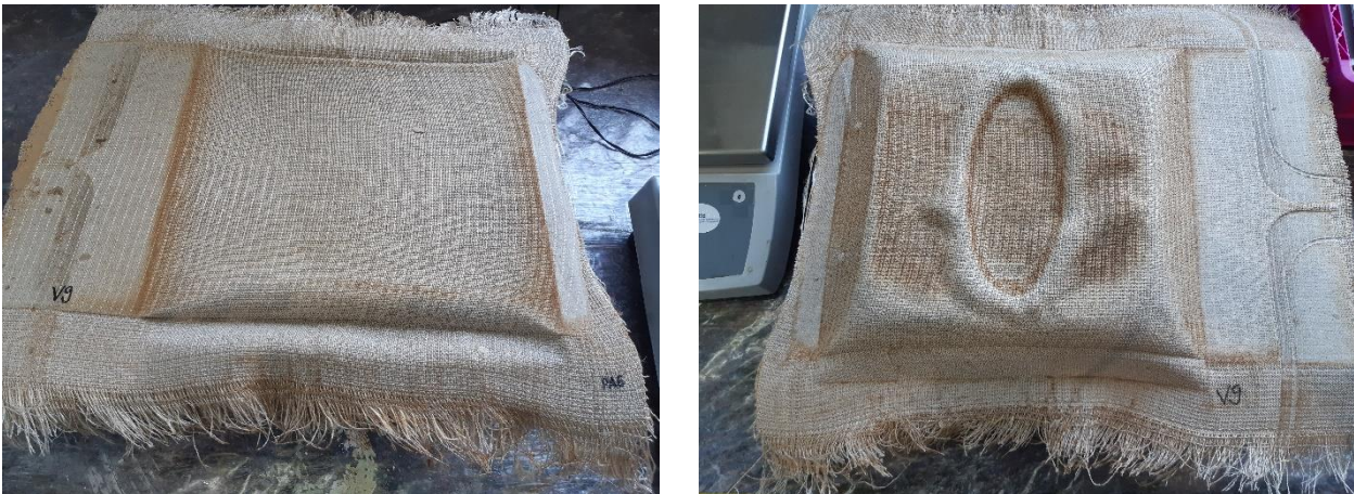
Abbildung 21 Geschäumtes Abstandsgewebe Versuch 9 nach Trocknung
