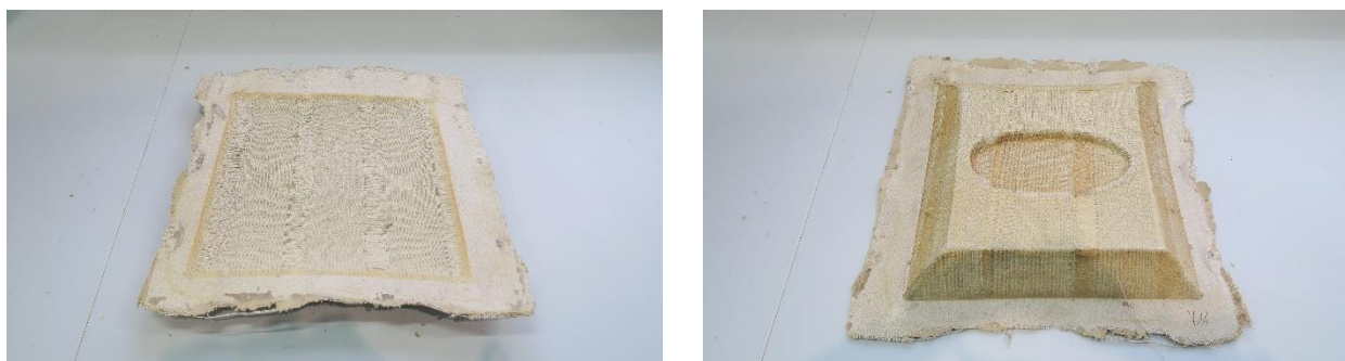
Abbildung 23 Geschäumtes Abstandsgewebe Versuch 11 nach Trocknung
