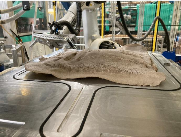
Abbildung 12 Wellen und unförmige Oberfläche aufgrund einer zu hohen Dichte an Polfäden
