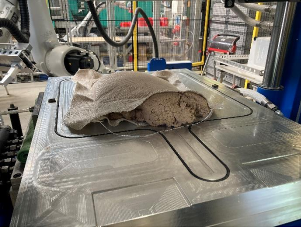
Abbildung 10 Frühzeitiges Schäumen vor Schließen des Werkzeugs
