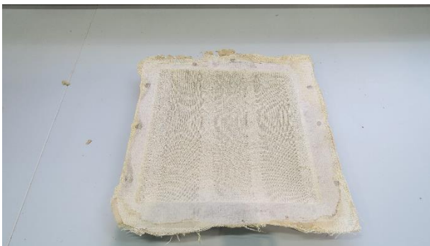
Abbildung 26 Geschäumtes Abstandsgewebe Versuch 14 nach Trocknung
