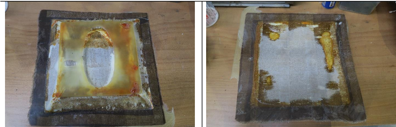
Abbildung 40 Vorversuche mit PU Schaum zur Validierung der Harzmenge
