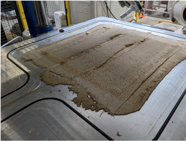
Abbildung 14 Geschäumtes Abstandsgewebe Versuch 1 nach Trocknung
