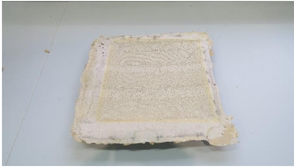
Abbildung 27 Geschäumtes Abstandsgewebe Versuch 15 nach Trocknung
