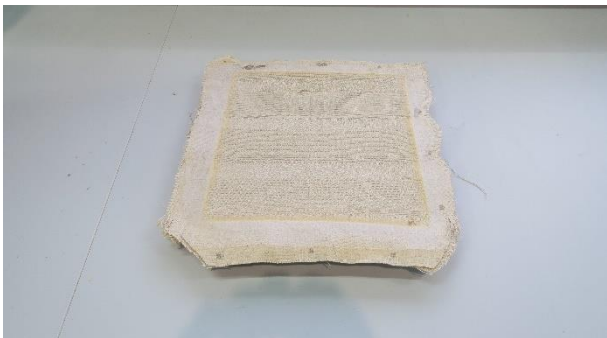
Abbildung 24 Geschäumtes Abstandsgewebe Versuch 12 nach Trocknung
