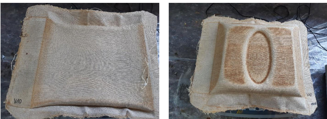
Abbildung 22 Geschäumtes Abstandsgewebe Versuch 10 nach Trocknung
