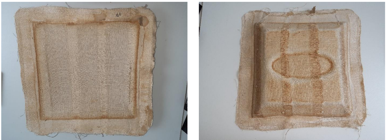
Abbildung 19 Geschäumtes Abstandsgewebe Versuch 7 nach Trocknung
