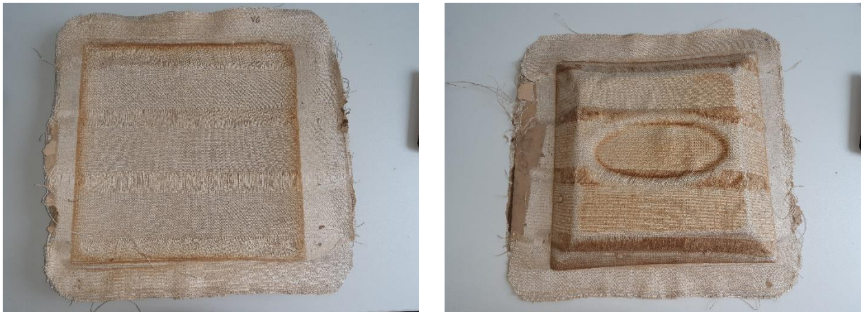
Abbildung 18 Geschäumtes Abstandsgewebe Versuch 6 nach Trocknung
