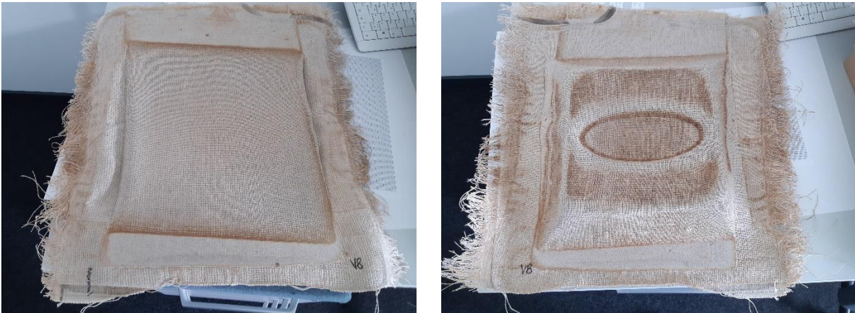
Abbildung 20 Geschäumtes Abstandsgewebe Versuch 8 nach Trocknung
