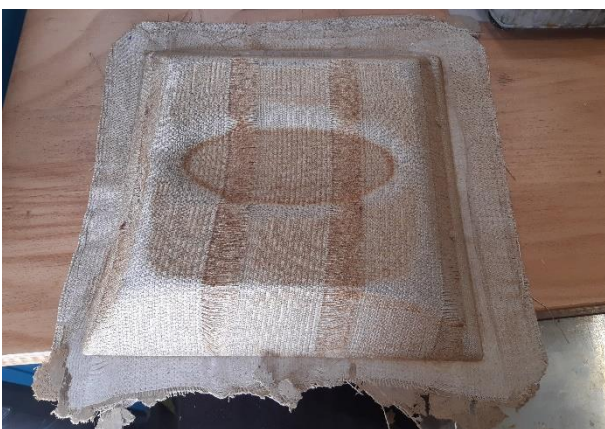
Abbildung 16 Geschäumtes Abstandsgewebe Versuch 4 nach Trocknung
