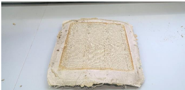
Abbildung 29 Geschäumtes Abstandsgewebe Versuch 17 nach Trocknung
