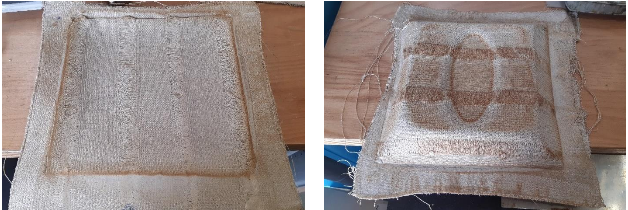
Abbildung 17 Geschäumtes Abstandsgewebe Versuch 5 nach Trocknung
