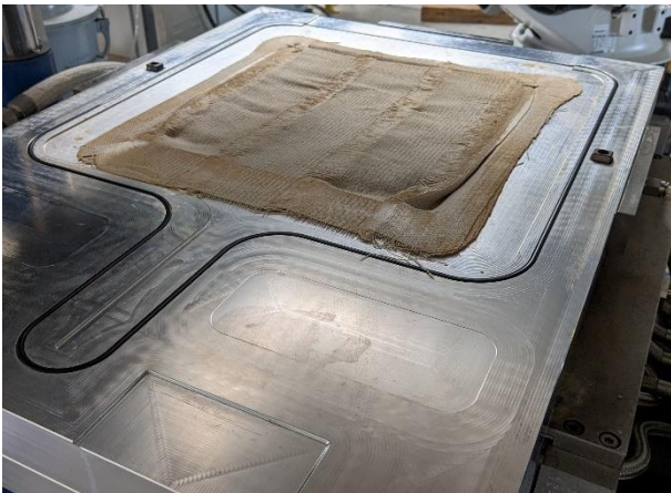
Abbildung 15 Geschäumtes Abstandsgewebe Versuch 2 nach Trocknung
