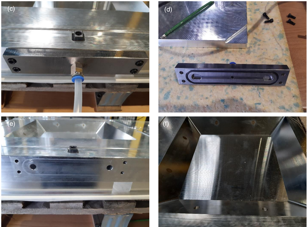
Abbildung 6 Werkzeug gefertigt durch TPK Kunststofftechnik; Werkzeugunterseite mit Rahmen (a), Entgasungspunkte geschlossen innen (b), Anschlussentgasungspunkt außen (c), Feuchtigkeitsführung im Inneren am Entgasungspunkt (d+e) und Werkzeug mit geöffneten Entgasungspunkten (f)
