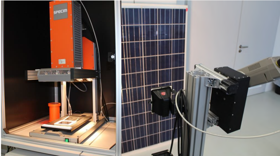
Abbildung 9. (links) Laboraufbau zur Datenerfassung von PV-Modul-Proben, (rechts) Aufbau mit Rotationsscanner zur großflächigen Datenerfassung.
