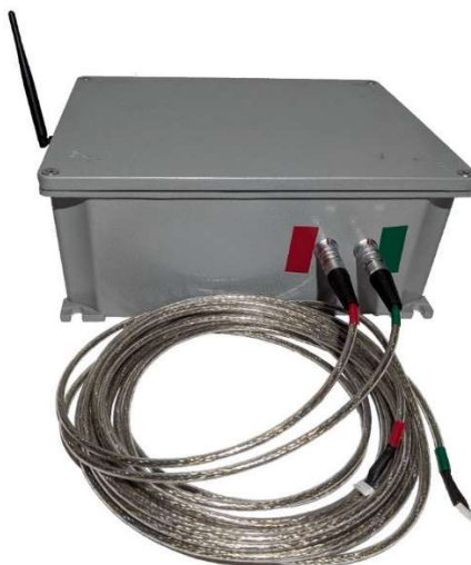
Abbildung 3: Großansicht: Alubox mit Antenne an der Seite und zwei Buchsen für Motor-Kabel und Anschlüsse für die Motoren an der Fußapparatur.
