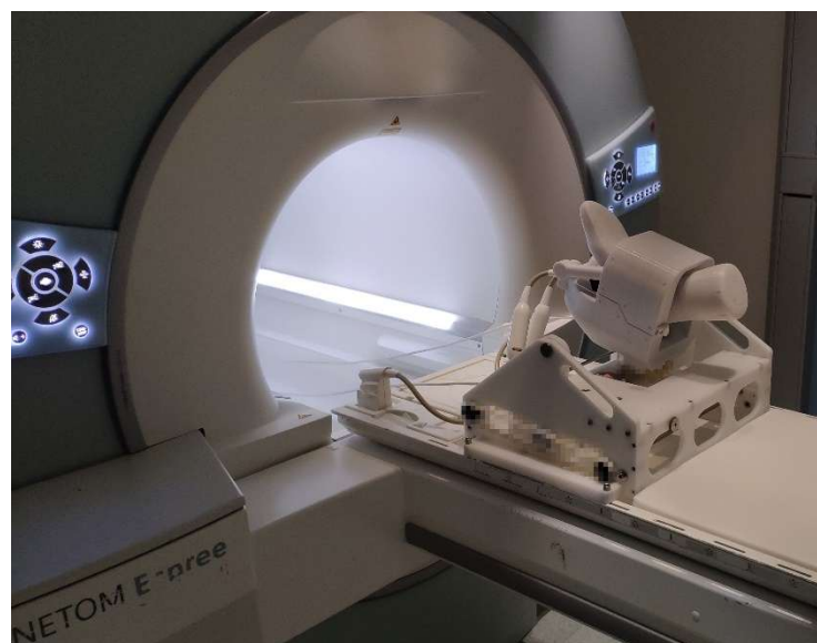
Abbildung 9: Seitenansicht Fußapparat mit 16-Kanal Spule und eingesetztem Fußphantom
