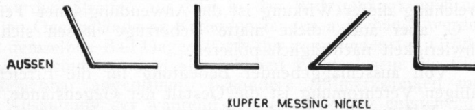
Bild 4. Winkel mit auf der Außenfläche aufgebrachtem Chromniederschlag.
