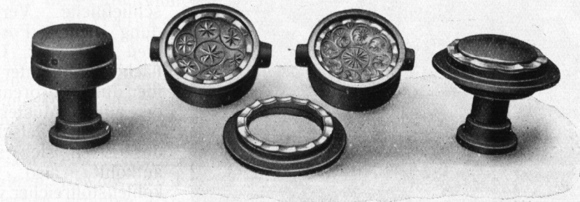
Bild 13. Bei der Siemens & Halske A.-G. verchromte Metallformen.
