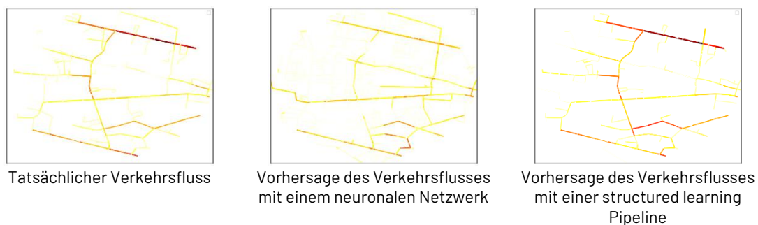
Abbildung 12: Visualisierung der Prognose von Verkehrsflüssen mittels eines neuronalen Netzwerkes und einer structured learning Pipeline.
