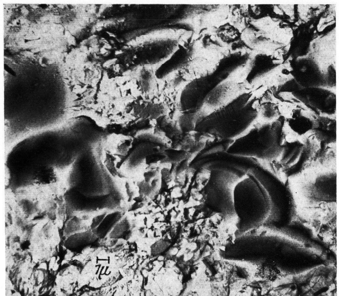
Bild 2. Spiegelglas, fein geschliffen; 3000 ×.
