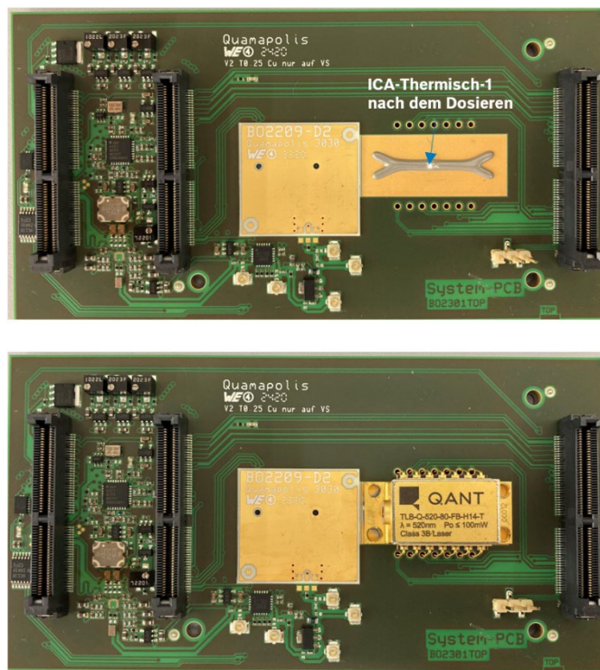
Abbildung 17: Oben dosierter ICA und unten das bestückte Butterfly-Package auf der Systemleiterplatte
