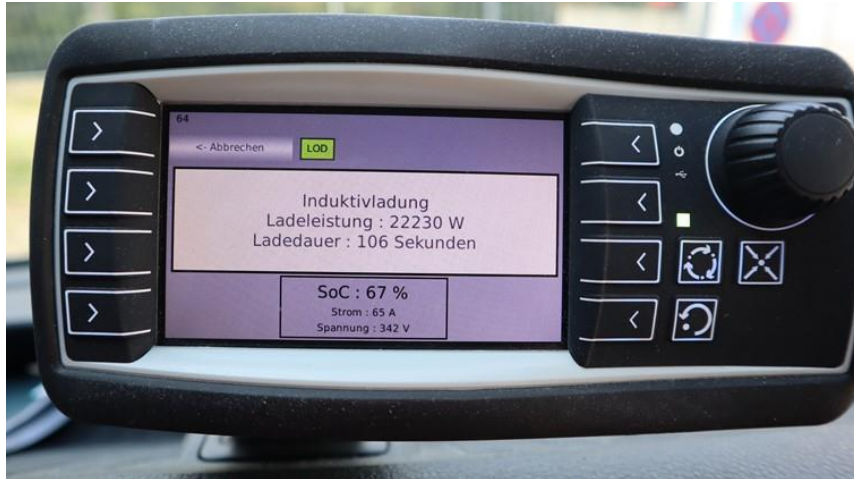
Abbildung 2-35: Benutzerschnittstelle mit Anzeige der Daten während des Ladevorgangs
