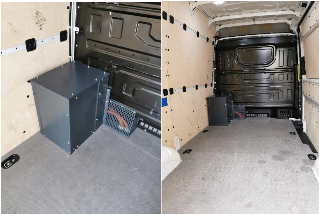
Abbildung 2-51: Einbauposition der sekundärseitigen Komponenten im Laderaum
