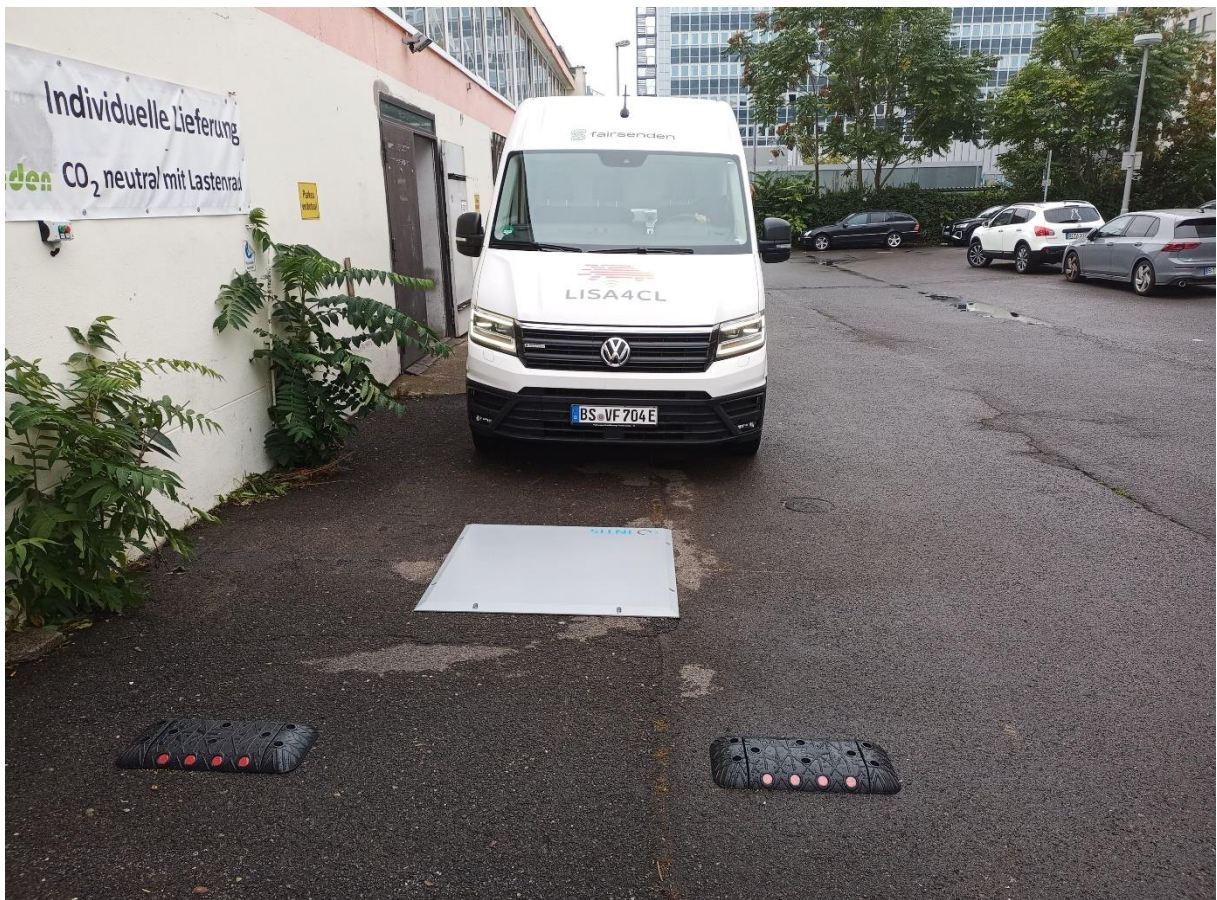
Abbildung 2-105: Einsatzbereite Primärkomponenten des Ladesystems in Berlin
