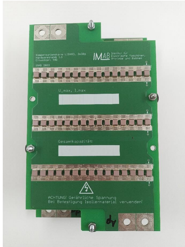
Abbildung 2-16: primärseitige Kompensationsbank, TUB-IMAB für Projekt LISA4CL
