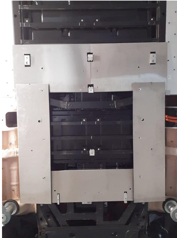
Abbildung 2-53: Schirmung am Unterboden mit Halteklammern
