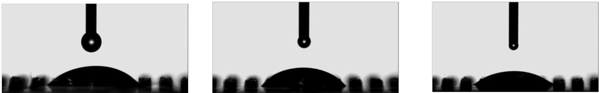
**Abb.12:** pH-abhängige Kontaktwinkelmessungen auf PAA beschichteten PDMS-Pillars
