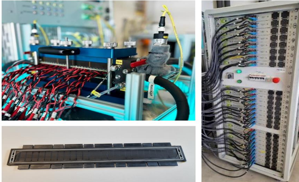
Abbildung 39: Segmentierte „Along-The-Channel“-Testzelle (oben links), segmentiertes Gas-Flussfeld mit Steckern zum Spannungsabgriff (unten links) und Mehrkanal-Potentiostaten-Anlage (rechts)
