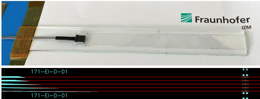
Abbildung 3: Oben: Foto einer besteckerten Glasprobe mit Wellenleitern und GISC Strukturen. Unten: Layoutausschnitt (180° gedreht und zwecks vollständiger Beschriftung größer als der tatsächliche Ausschnitt im Foto), mit den Lichtwellenleitern in rot und der Beschriftung, den Justagemarken und den Diffusionsmasken für die Ausdiffusion in türkis.
