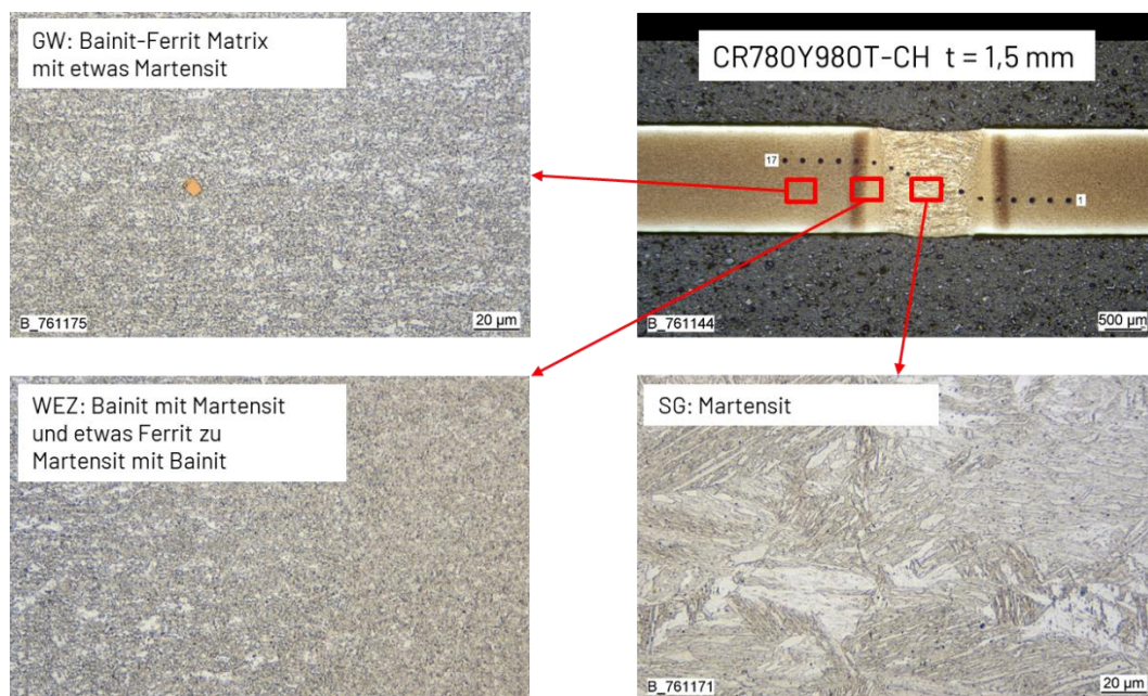
Abbildung 7: Mikrostruktur Verbindung CR780Y980T-CH t = 1,5 mm
