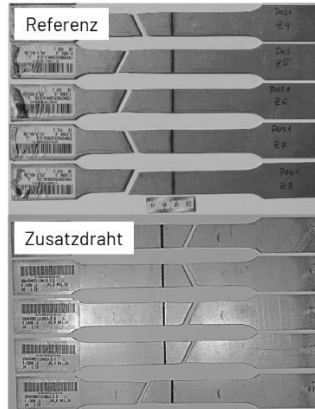
Abbildung 38: Zugfestigkeiten Grundwerkstoff: 1. Säule von links, und geschweißte Verbindung: 2. und 3. Säule von links sowie Bruchbilder der geschweißten Verbindungen
