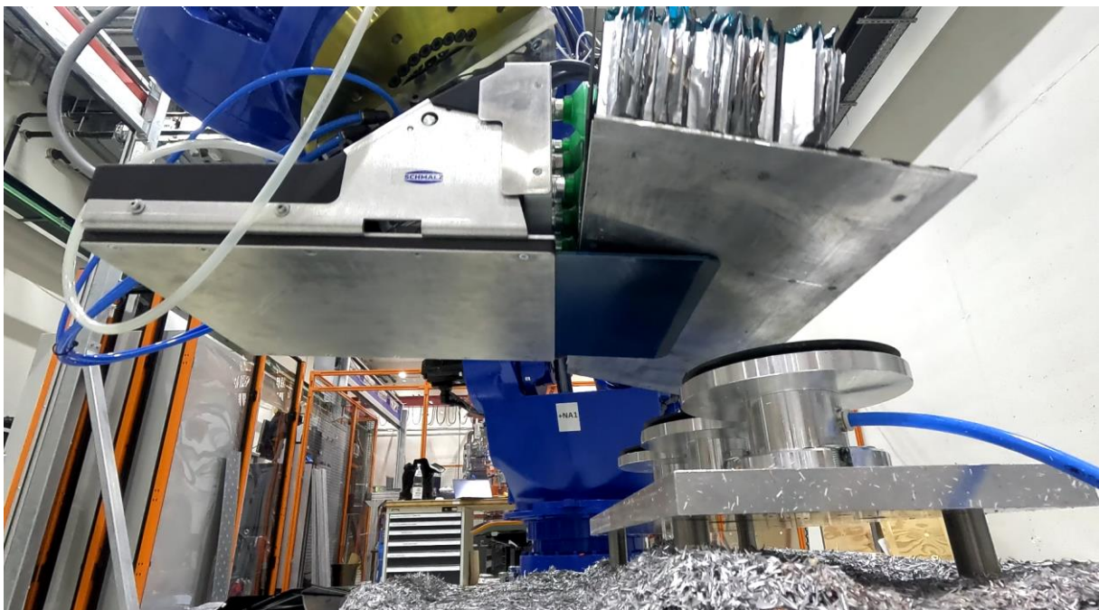
Abbildung 6: Unterschubgreifer: Vakuumsauggreifer greifen das Werkstück von der Seite und heben es leicht an (oben), danach wird eine Platte „untergeschoben“ und das Werkstück kann auf der Platte liegend gesichert transportiert werden (unten)
